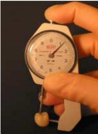
Abb. 15: Messung der Dicke eines Provisoriums mit dem Tasterzirkel
