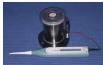
Abb. 8: Probenhalter und Prepometer<sup>®</sup>
