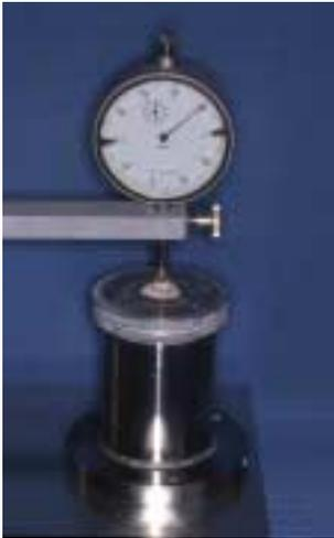
Abb. 6: Versuchsaufbau mit Probenhalter und Messuhr
