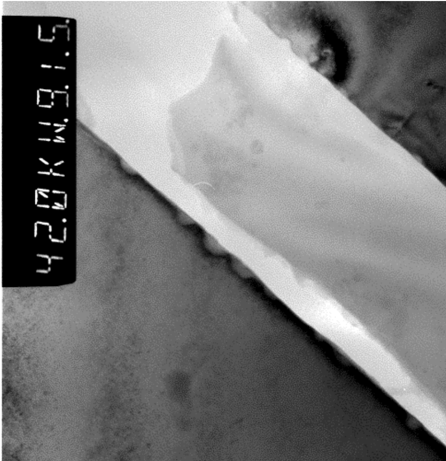
Abb. 3.3.16: TEM-Aufnahme der Probe #13080 (150nm). Zu sehen sind die linsenförmigen Cluster an der Schichtoberfläche. Die Größe der Cluster beträgt meistens etwa 35x13nm. Das Verhältnis von Höhe zu Breite wird mit 0,4 gut beschrieben.
