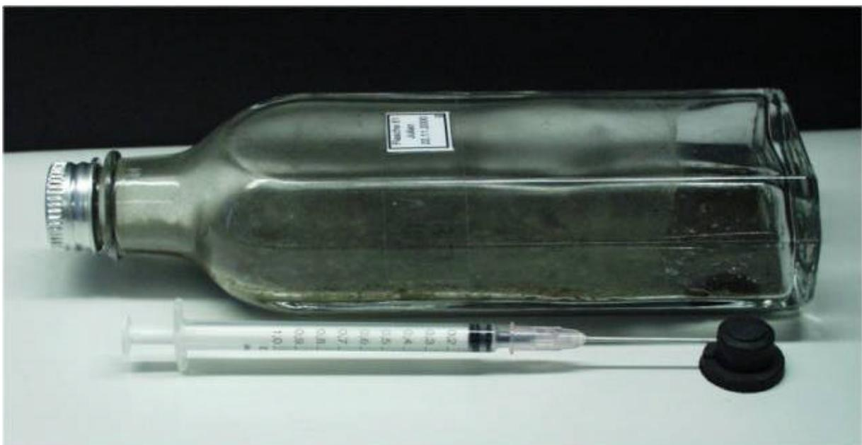
**Abbildung 3.1:** Gasdichte Flasche mit inkubiertem Reisfeldboden (Grundaufbau).
