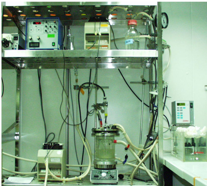
Abbildung II-1. Chemostatanlage. In der Mitte der unteren Bildhälfte ist der Fermenter zu sehen. Links davon die das Medium zuführende peristaltische Pumpe. Im oberen Teil befindet sich der pH-Regler, der die peristaltische Pumpe zur Zufuhr von NaOH steuert.
