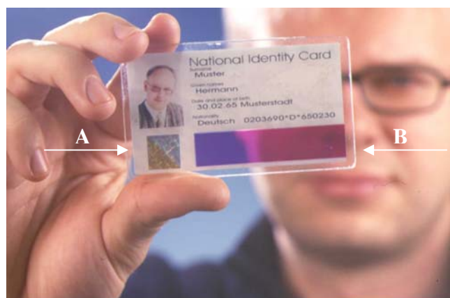
Abb. 140: Beispiel für eine ID-Card mit mehreren Sicherheitselementen auf BR-Basis. A: Photochromes OVD. B: Optischer WORM-Speicher.
