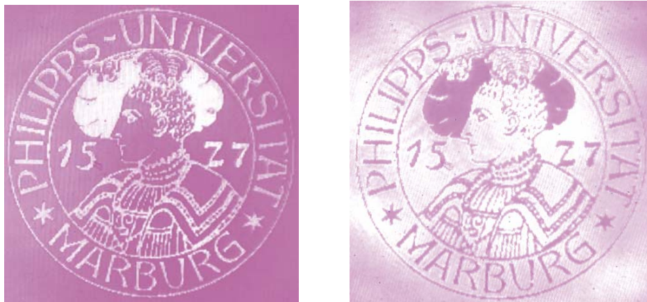
Abb. 92: In BR gespeicherte Mikrobilder (Methode P, WT, OD 1.6, E = 7 \text{ J/cm}^2 , f = 10 \text{ Hz} ).
