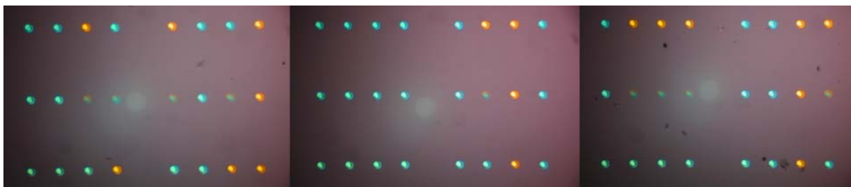
Abb. 93: In BR gespeicherter Datensatz (siehe Tab. 30) aufgenommen unter 45^\circ (Methode S, D96N, OD 1.7, E = 2.7 \text{ J/cm}^2 , f = 10 \text{ Hz} ).
