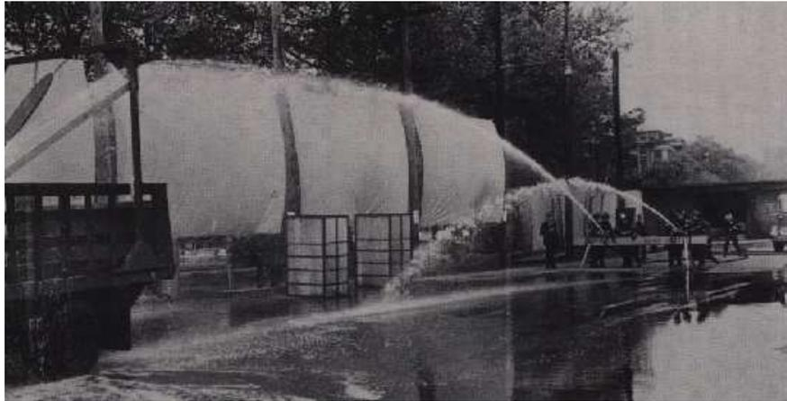
Abbildung 1.1: Demonstration der turbulenten Widerstandsreduktion. Durch zwei baugleiche Schläuche wird Wasser (rechts) und Wasser mit Polymerzusatz (links) verspritzt. Aufgrund des reduzierten Strömungswiderstands des Wassers mit Polymerzusatz ist die Reichweite deutlich größer.
