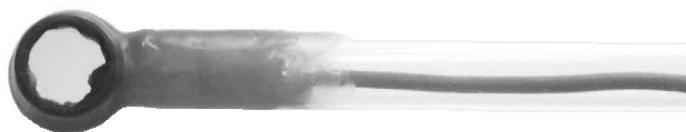
**Abb. 21:** Kontaktierte und lackierte Arbeitselektrode
