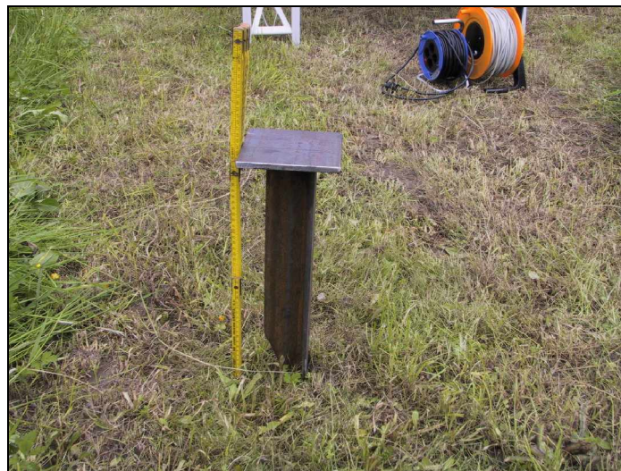
Abbildung 52: Erdspeiß zur Ankopplung der Schwingungsaufnehmer an das Erdreich
