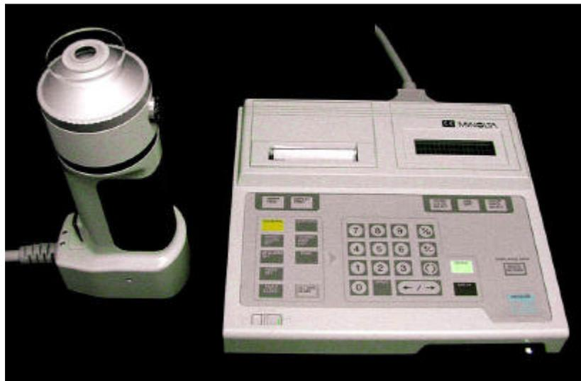
**Abbildung 1.11:** Chromameter CR 300® der Firma Minolta (Japan)
