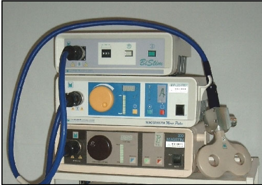
Abbildung 8: Das verwendete BiStim-Modul, die Magnetstimulatoren und die fokale Schmetterlings-Spule mit 70 mm internem Durchmesser.
