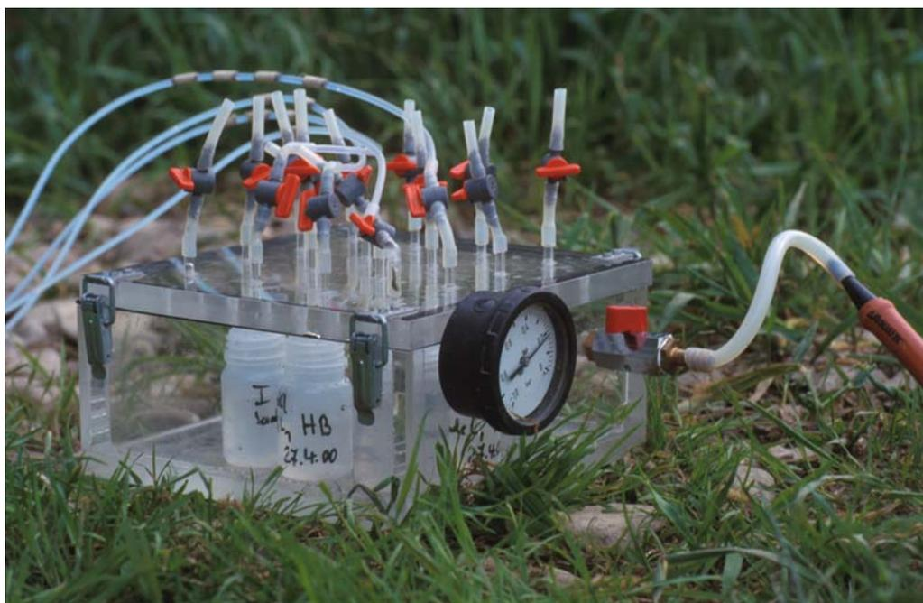
Unterdruckkasten zur Interstitialwasserentnahme aus Multilevelsonden
