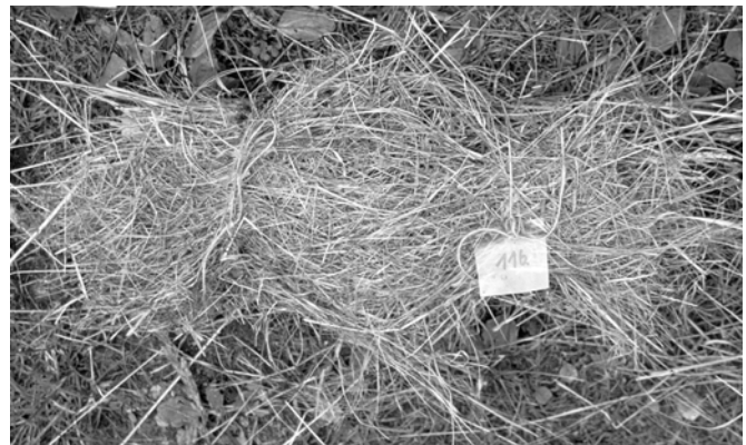
Abb 23: An der Elbe verwendete Bündel aus Pflanzenmaterial. Bestandteil waren jeweils 4 größere Hölzer (etwa 5 cm Durchmesser, 60 cm Länge) und Heu. Das Material wurde durch eine Schnur fixiert und durch beschriftete Folien nummeriert (Größe: 60 cm x 25 cm x 5 cm).
