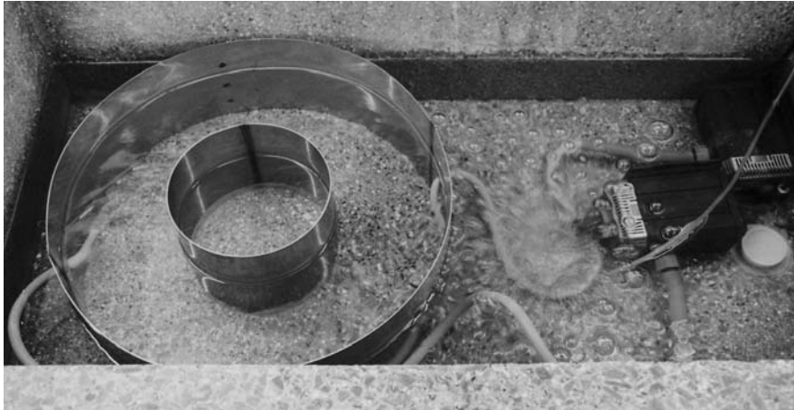
Abb. 24: Rundstrombecken zur Bestimmung der Schwimmdauer von Gehäuseschnecken auf der Wasseroberfläche. In zwei ineinander gestellten Edelstahlzylindern wurde ein Wasserstrom erzeugt, indem mit Hilfe zweier Pumpen Wasser in den äußeren Zylinder gepumpt wurde. Da die genutzten Pumpen das Wasser gegenüber der Umgebung erwärmten, war die Wassertemperatur etwas höher als die Lufttemperatur (s. Tab. 12). Es erfolgte eine kontinuierliche Luftzufuhr.
