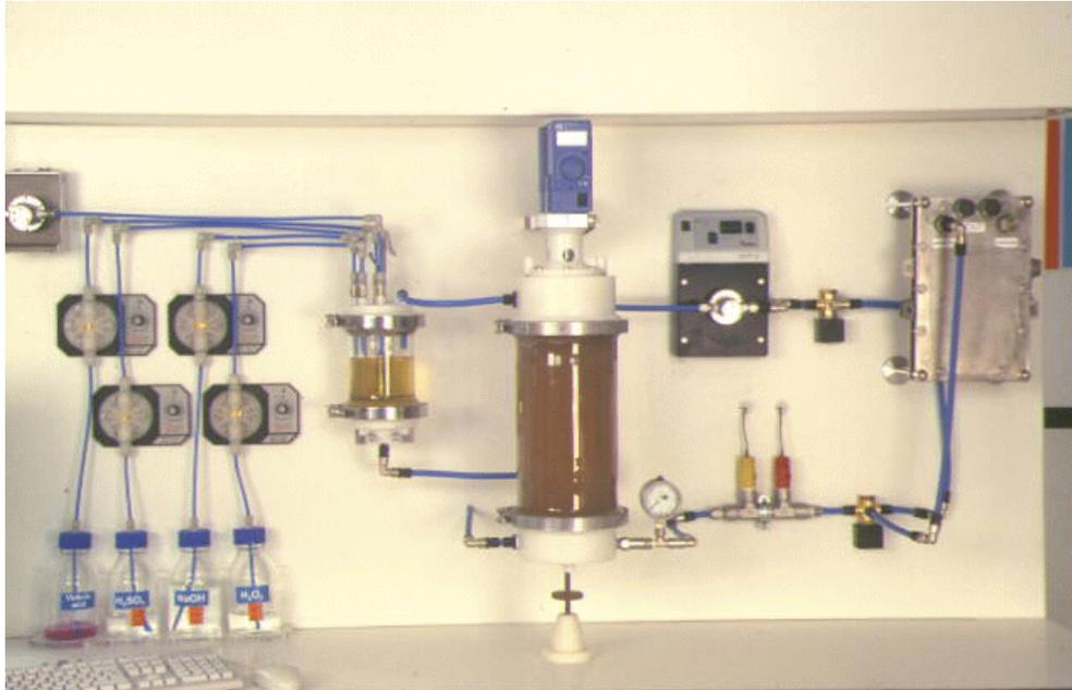
**Abb. 42** Ein EMB-Modellsystem mit externer Radikalgenerierung. Die „Pilot-Anlage“ wurde im Jahr 2000 auf der ACHEMA in Frankfurt vorgestellt.
