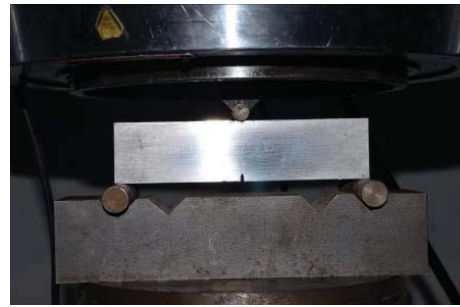
Figura 10: Utillaje acoplado a la máquina de ensayos Instron.
