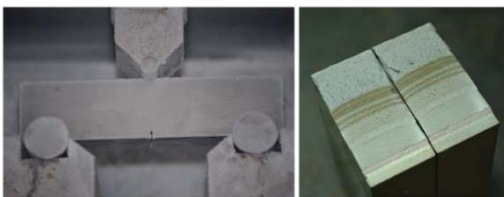
Figura 5. Rotura frágil (izq) y detalle de la zona de la propagación de la grieta (der).
