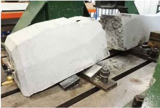
Figura 9. Estado final de la travesía tras el ensayo.
