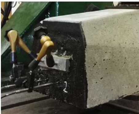
Figura 5. Registro de pérdida de adherencia de las armaduras.
