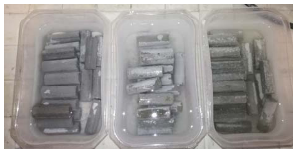
Figura 1. Minimorteros durante la fase de curado
