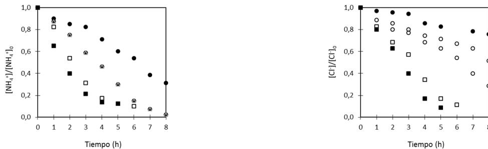
Figura 6. Eliminación de amonio,  $J = \bullet$  300,  $\circ$  450,  $\blacktriangle$  600,  $\square$  900 y  $\blacksquare$  1200 A/m<sup>2</sup>.
