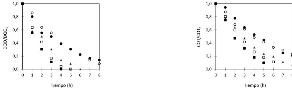
Figura 5. Influencia de  $J$  en la eliminación de: a) DQO y b) COT,  $J = \bullet$  300,  $\circ$  450,  $\blacktriangle$  600,  $\square$  900 y  $\blacksquare$  1200 A/m<sup>2</sup>.
