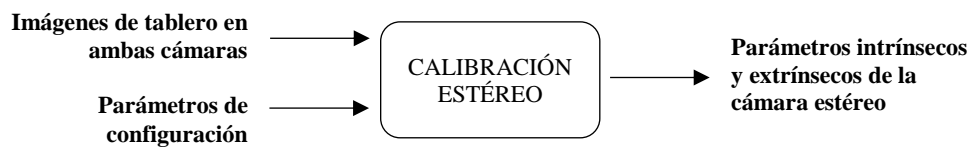
FIGURA 4.2: ESTRUCTURA DE LA PARTE DE CALIBRACIÓN ESTÉREO
