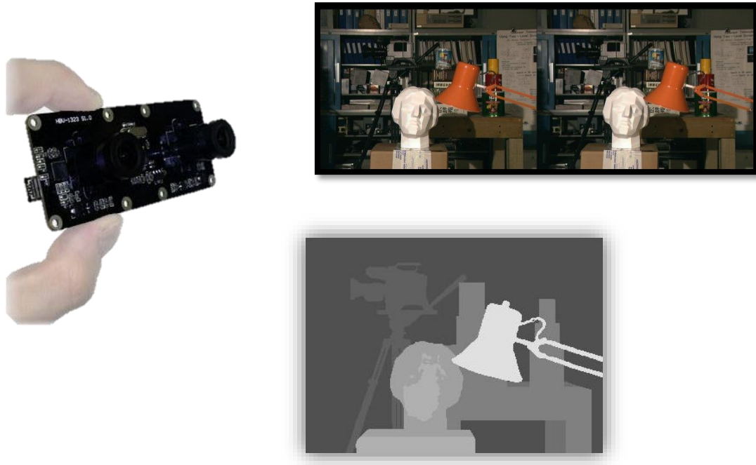
FIGURA 2.6: A LA IZQUIERDA, SISTEMA TÍPICO DE CÁMARA ESTERO. A LA DERECHA, EJEMPLO DE STEREO MATCHING A PARTIR DE LAS IMÁGENES DE TSUKUBA UTILIZANDO GROUND TRUTH 1 .
