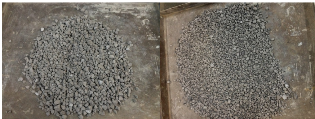
Figura 3.31. Aspecto de la muestra de escoria sin cribar antes y después del ensayo.
