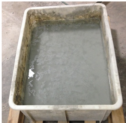
Figura 3.39. Detalle de la escoria decantada en el fondo del recipiente.
