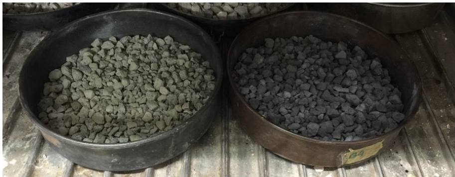
Figura 3.23. Muestras de áridos tras el secado en estufa a 110 \pm 5 °C.
