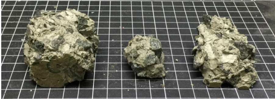
Figura 4.54. Aspecto del HAC-GOF-FC tras 7 ciclos de hielo-deshielo.
