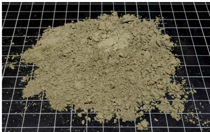
Figura 3.62. Aspecto del cemento portland tipo I 52,5 R.
