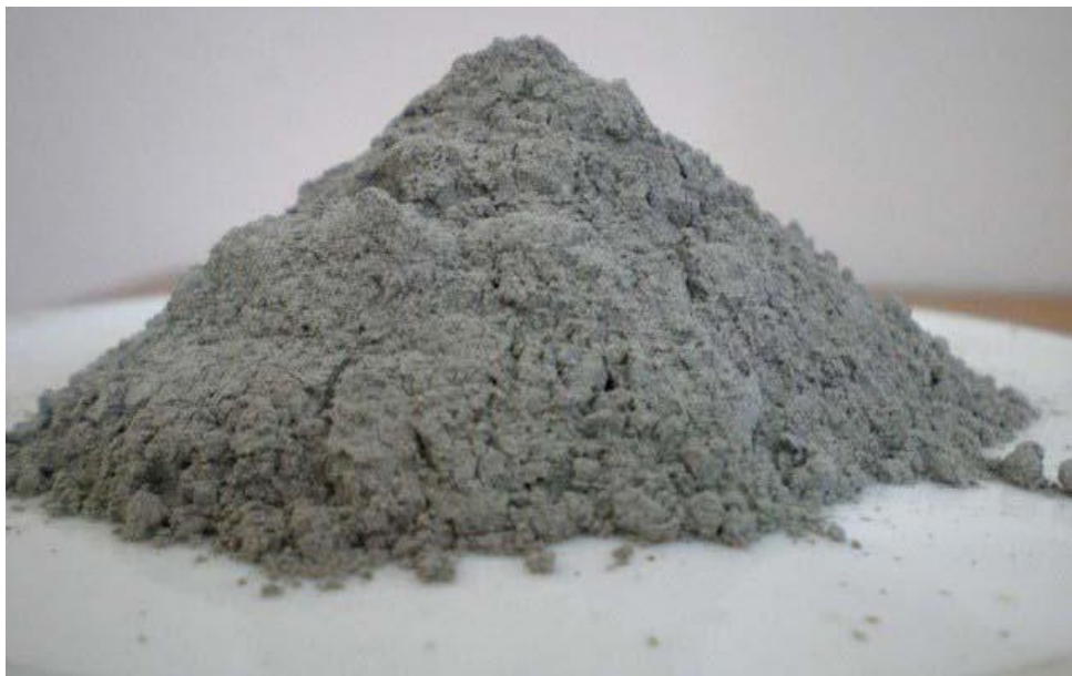
Figura 2.18. Aspecto de las cenizas volantes (fuente: www.arthaminerals.com ).
