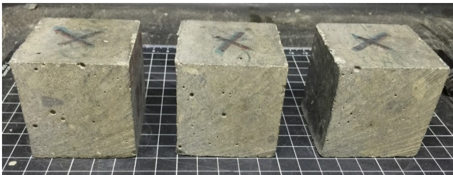
Figura 4.43. Aspecto del HAC-GOF-CV tras los ciclos de humedad-sequedad.
