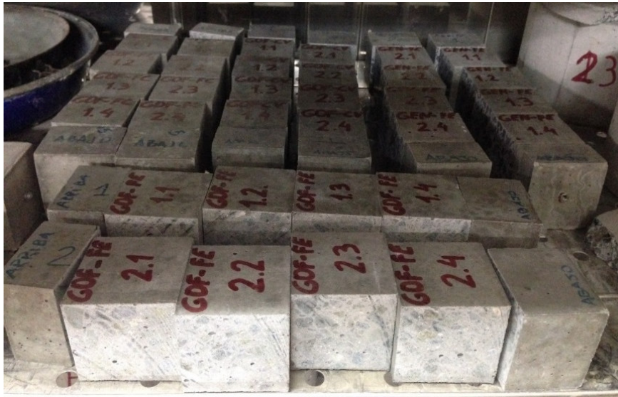
Figura 3.119. Aspecto de las probetas cúbicas obtenidas tras el corte de los prismas.
