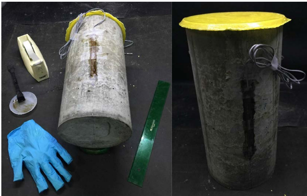
Figura 3.104. Aspecto de las galgas extensométricas adheridas a la probeta de ensayo.
