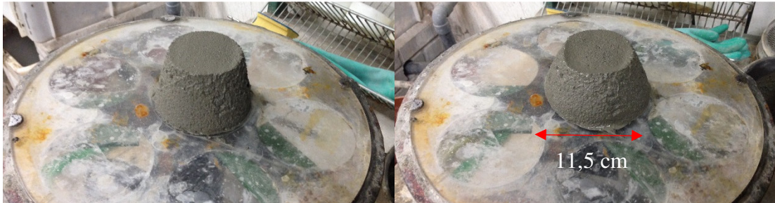
Figura 3.74. Consistencia del mortero fresco con un 20% de sustitución de cemento por escoria antes y después de 15 sacudidas.
