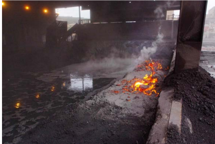
Figura 2.10. Enfriamiento de las escorias sobre el nivel del agua.
