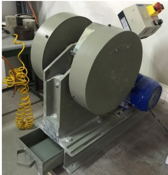
Figura 3.36. Machacadora empleada antes de realizar la molienda de la escoria de cubilote.
