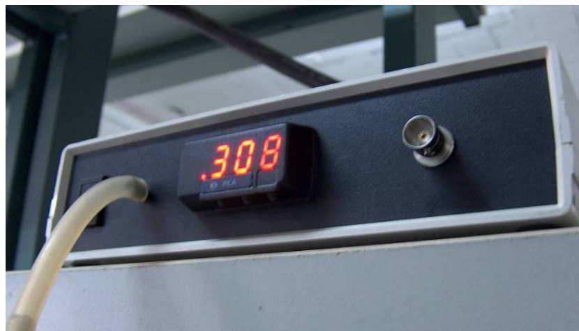
Figura 3.116. Caudalímetro digital empleado para determinar el flujo de oxígeno a la salida de la muestra.
