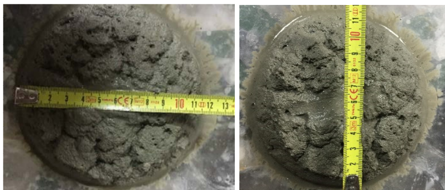
Figura 3.66. Ensayo de la mesa de sacudidas de mortero con el aditivo Fluid Premia.
