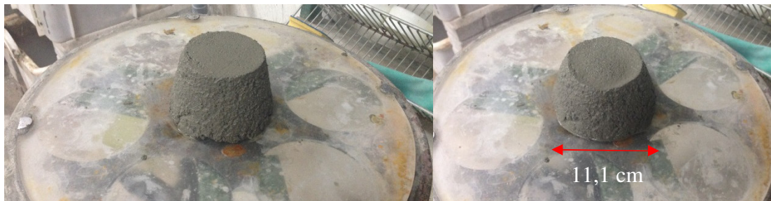
Figura 3.73. Consistencia del mortero fresco con un 10% de sustitución de cemento por escoria antes y después de 15 sacudidas.
