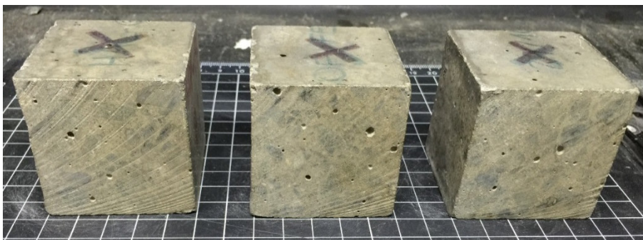
Figura 4.44. Aspecto del HAC-GOF-FE tras los ciclos de humedad-sequedad.
