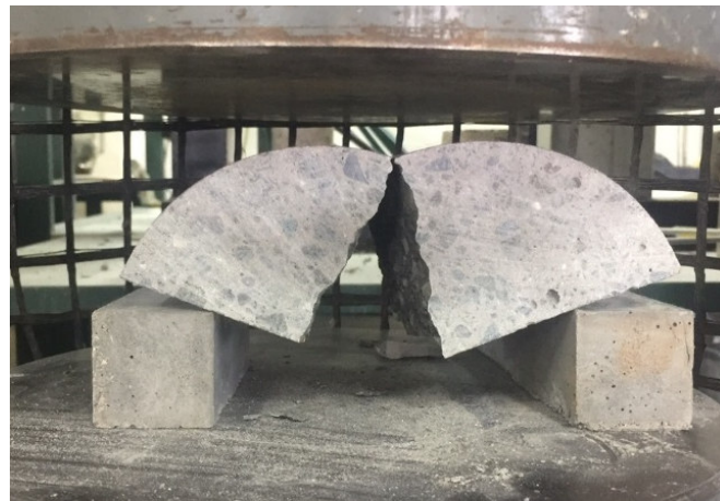
Figura 3.114. Rotura de las probetas tras la carbonatación acelerada.
