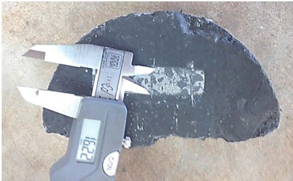
Figura 3.109. Medición de la huella de desgaste con el calibre.
