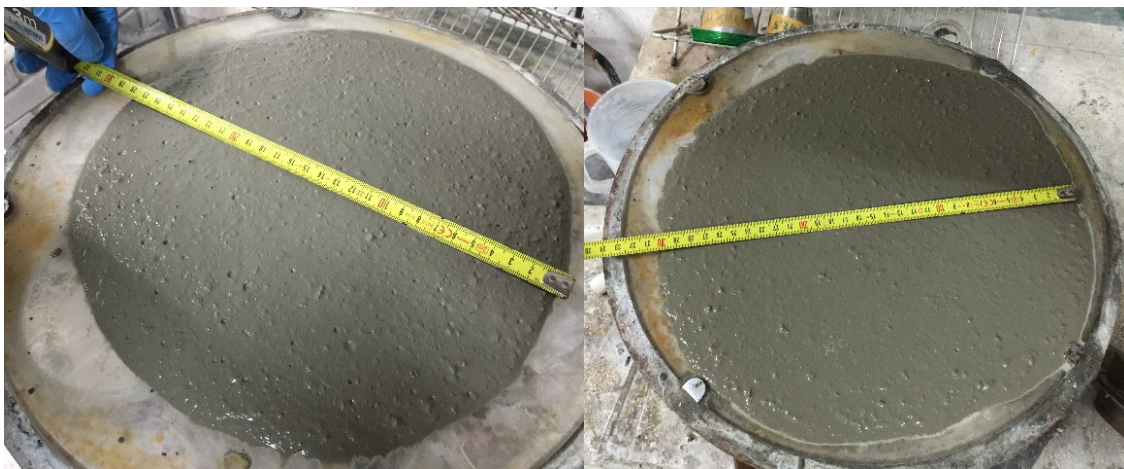
Figura 4.5. Aspecto de la torta de escurrimiento de los morteros M-AOF-FC (izq.) y M-AOF-FE (dcha.) con una relación agua/cemento de 0,4.
