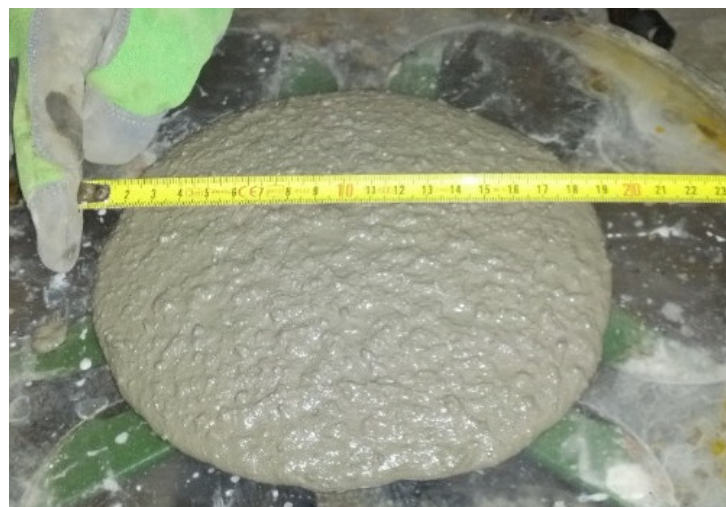
Figura 3.80. Mortero fabricado con filler calizo.
