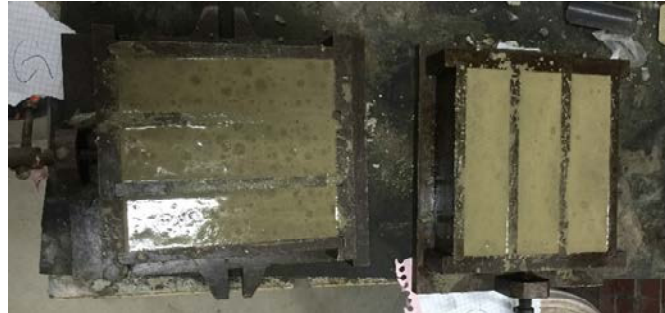
Figura 3.68. Morteros frescos para la fabricación de probetas prismáticas.
