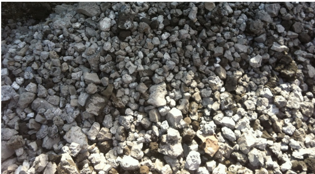
Figura 2.7. Aspecto de la escoria de horno eléctrico de arco enfriada.
