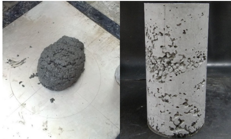
Figura 4.2. Aspecto del primer hormigón HAC-GEN-FE.
