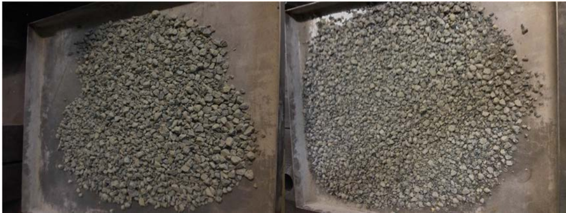
Figura 3.55. Aspecto de la muestra de gravilla de ofita (sin cribar) antes y después del ensayo de machacabilidad y su extracción del recipiente (dcha.).
