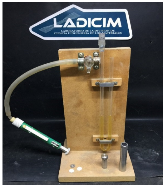
Figura 3.42. Permeabilímetro Blaine, celda y filtros empleados.
