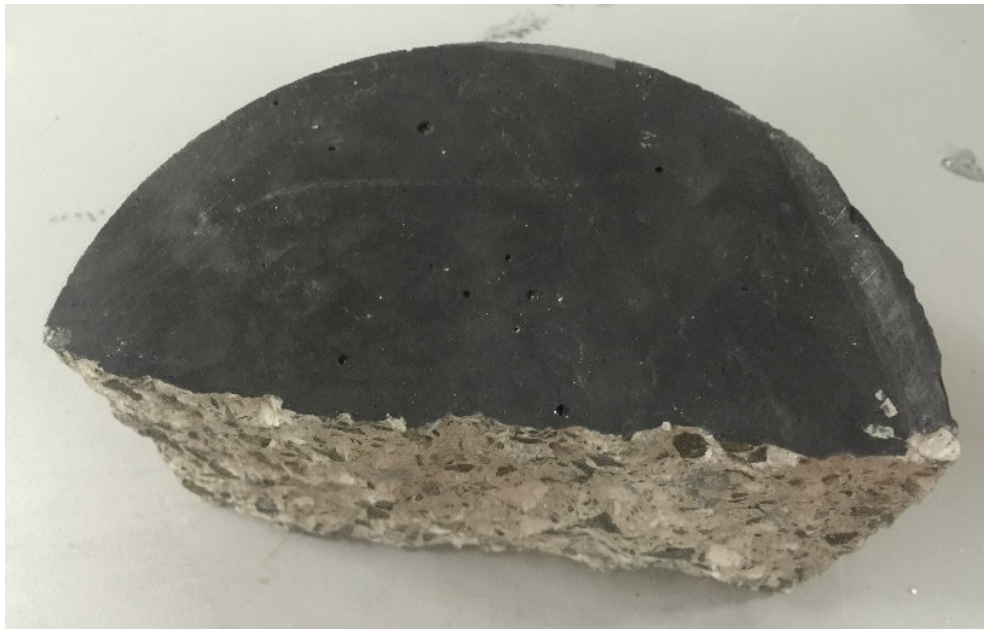
Figura 3.107. Detalle de una probeta pintada antes de someterse al proceso abrasivo.
