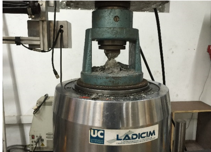
Figura 3.76. Ensayos de compresión de morteros con escoria de cubilote.
