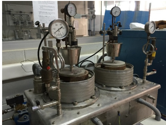
Figura 3.14. Equipo de ensayo empleado en la determinación de la expansividad de las escorias de horno eléctrico de arco.
