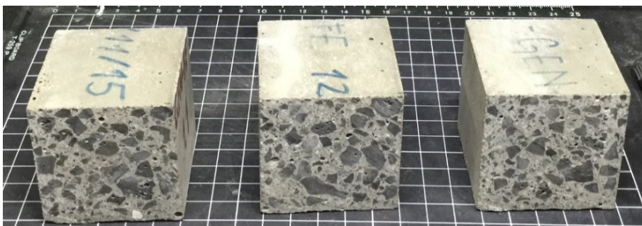
Figura 4.49. Aspecto del HAC-GEN-FE antes de los ciclos de hielo-deshielo.
