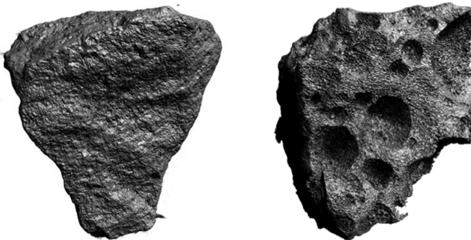
Figura 4.1. Comparación de la superficie de las partículas de gravilla de ofita (izda.) y escoria de horno eléctrico (dcha.).
