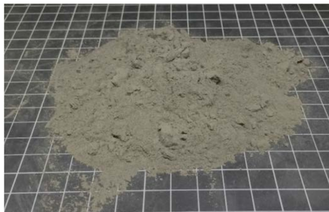
Figura 3.58. Aspecto de las cenizas volantes.
