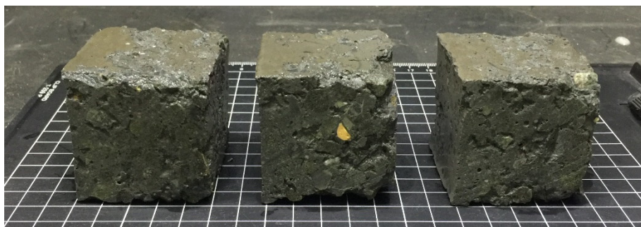
Figura 4.59. Aspecto del HAC-GOF-CV tras 15 ciclos de hielo-deshielo.
