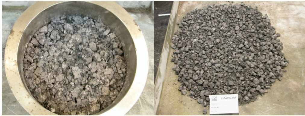
Figura 3.30. Aspecto de la fracción de grava de escoria tras el ensayo.
