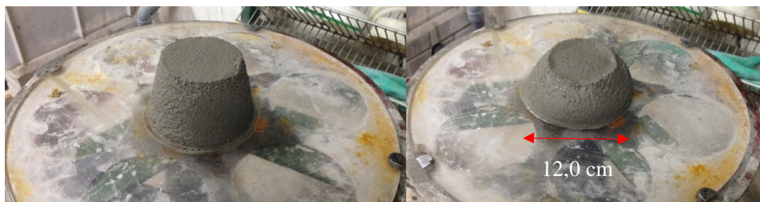
Figura 3.75. Consistencia del mortero fresco con un 30% de sustitución de cemento por escoria antes y después de 15 sacudidas.
