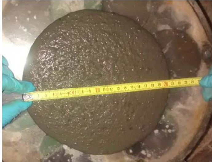
Figura 3.81. Mortero fabricado con cenizas volantes.
