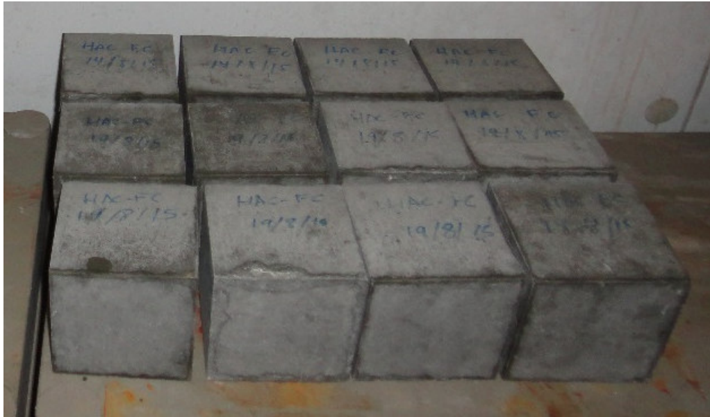
Figura 3.92. Aspecto de las probetas cúbicas.
