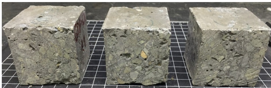
Figura 4.51. Aspecto del HAC-GOF-CV tras 5 ciclos de hielo-deshielo.
