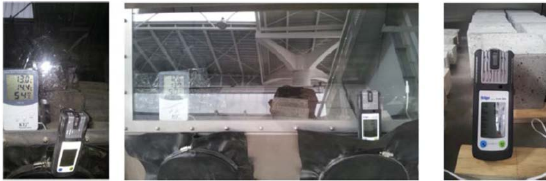
Figura 3.112. Equipos medición empleado para condiciones ambientales y la concentración de CO 2 .
