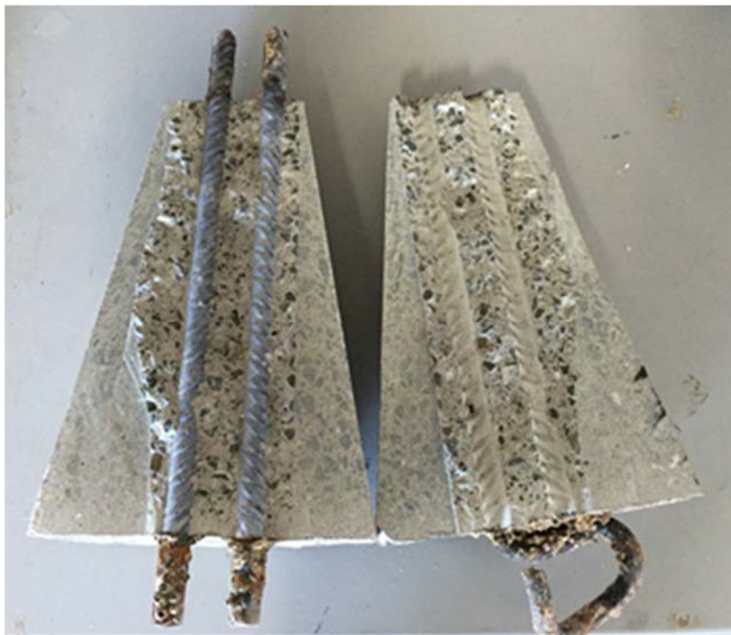
Figura 3.138. Aspecto de la probeta troncocónica tras la separación en dos mitades.
