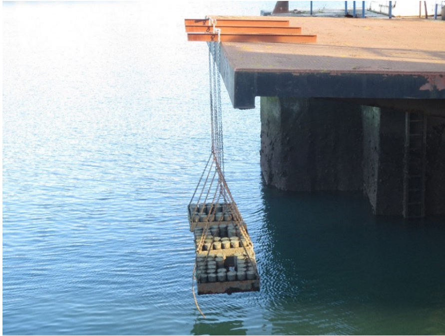
Figura 3.134. Ubicación de las probetas en carrera de mareas en el Puerto de Bilbao.
