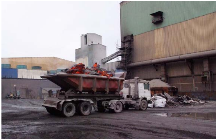
Figura 2.8. Transporte de las escorias tras ser retiradas de la colada.
