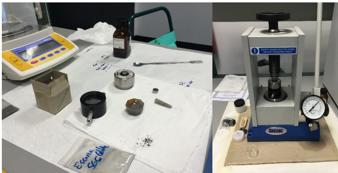
Figura 3.12. Preparación de la muestra para la espectroscopía mediante infrarrojos.
