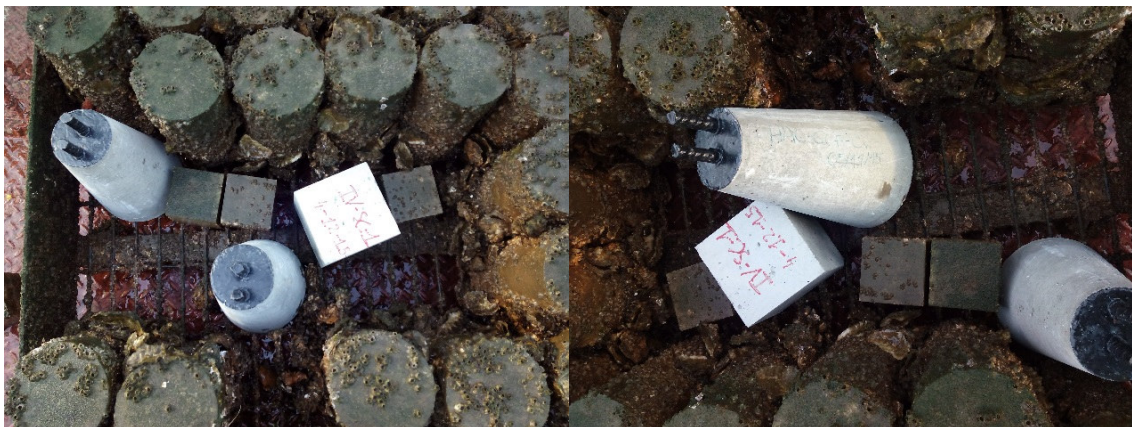
Figura 3.133. Disposición de las probetas en las rejillas metálicas.
