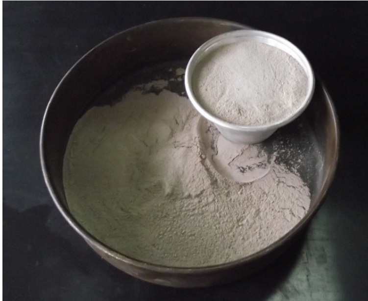
Figura 2.17. Aspecto del filler calizo.
