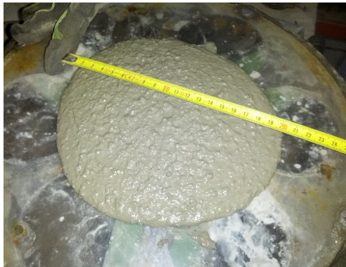
Figura 3.82. Mortero fabricado con escoria de cubilote.
