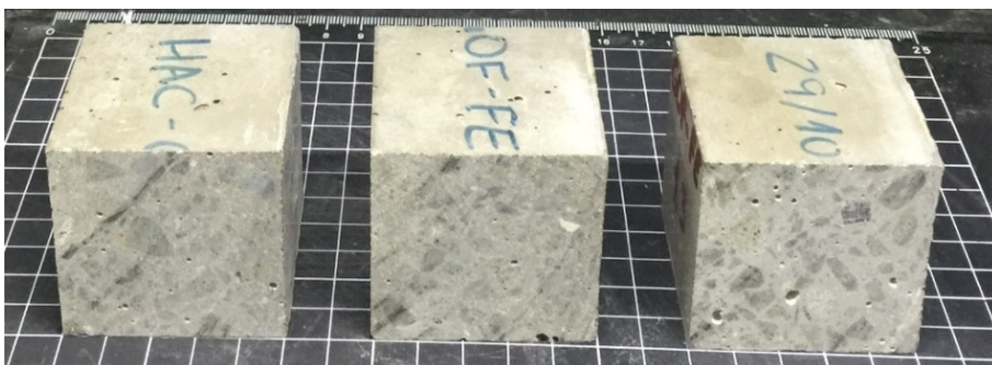
Figura 4.48. Aspecto del HAC-GOF-FE antes de los ciclos de hielo-deshielo.
