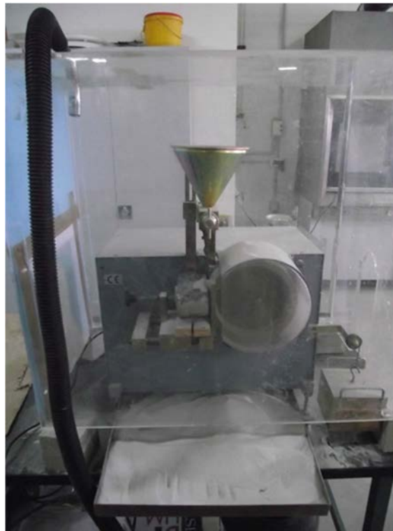
Figura 3.108. Equipo utilizado para los ensayos de abrasión por desgaste.
