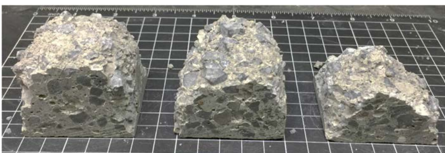
Figura 4.62. Aspecto del HAC-GEN-FE tras 21 ciclos de hielo-deshielo.
