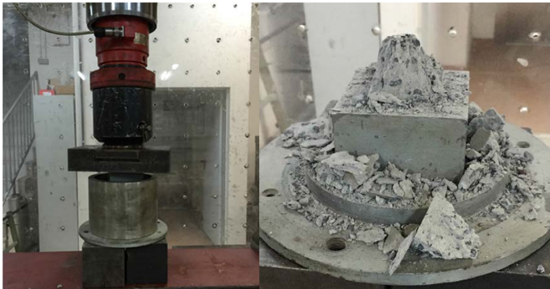
Figura 3.123. Caracterización mecánica de los cubos tras someterlos a los ciclos de humedad-sequedad.
