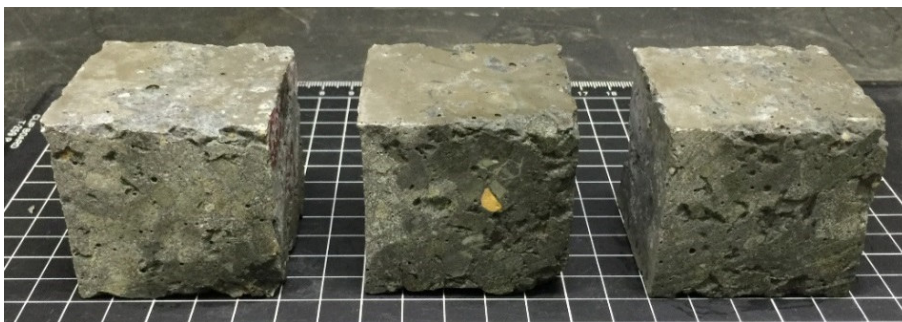
Figura 4.55. Aspecto del HAC-GOF-CV tras 10 ciclos de hielo-deshielo.
