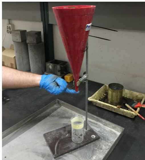
Figura 3.70. Cono de Marsh empleado para determinar el punto de saturación del aditivo.
