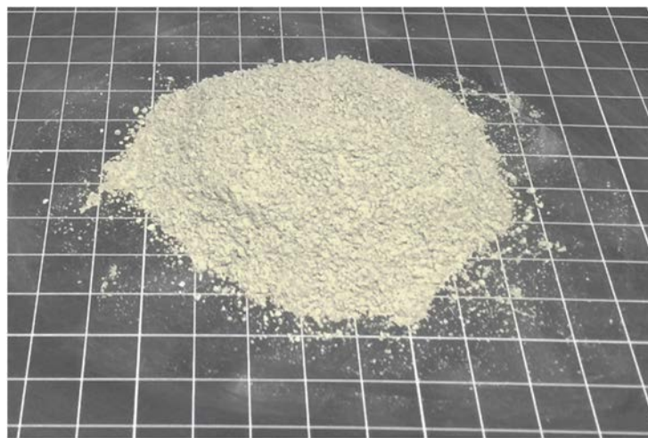
Figura 3.41. Aspecto de la escoria de cubilote molida.
