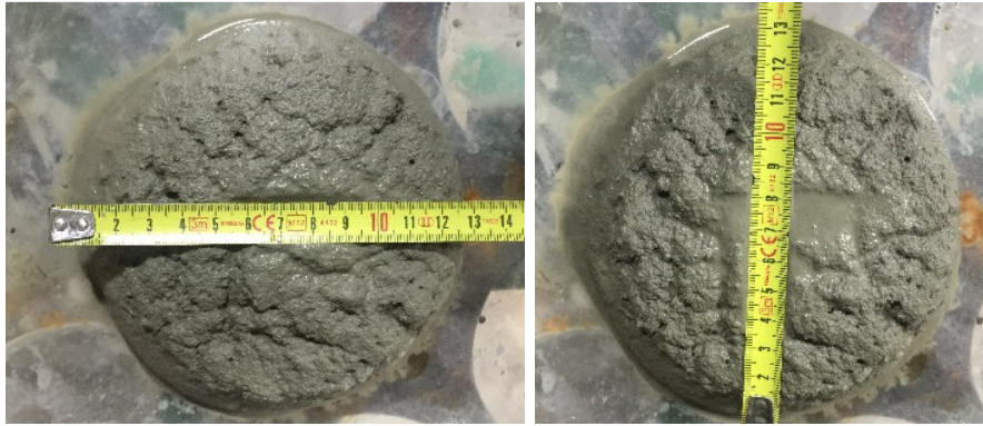
Figura 3.65. Ensayo de la mesa de sacudidas de mortero con el aditivo Master Glenium.
