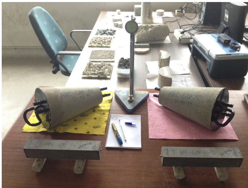
Figura 3.110. Probetas y equipo empleado para la determinación de la retracción.
