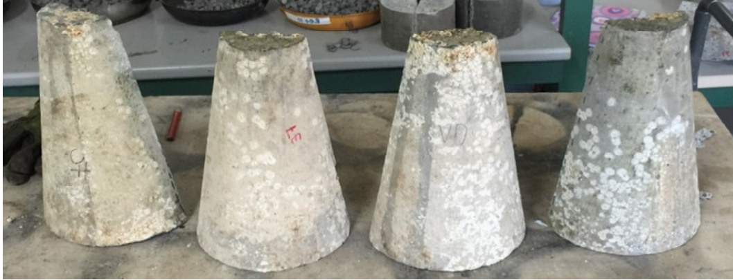
Figura 4.63. Exterior de las probetas cónicas HAC-GOF-FC, HAC-GOF-FE, HAC-GOF-CV y HAC-GEN-FE tras la exposición al contacto con agua de mar.
