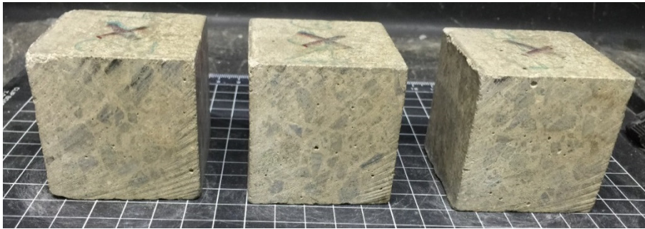
Figura 4.42. Aspecto del HAC-GOF-FC tras los ciclos de humedad-sequedad.
