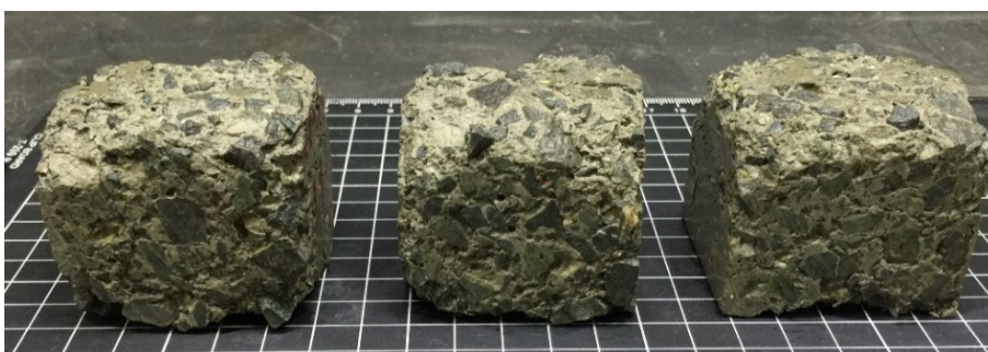
Figura 4.56. Aspecto del HAC-GOF-FE tras 10 ciclos de hielo-deshielo.
