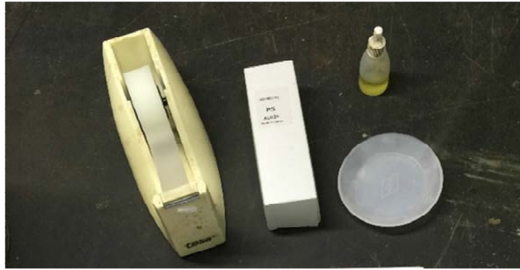
Figura 3.103. Pegamento bicomponente empleado en la colocación de galgas extensométricas.
