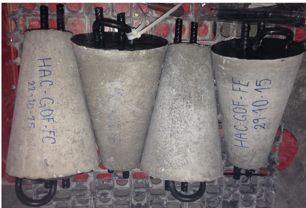
Figura 3.95. Aspecto de las probetas cónicas fabricadas.
