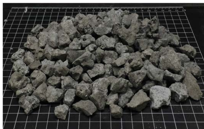
Figura 3.5. Grava de escoria de horno eléctrico de arco ( 12 < D < 20 mm).
