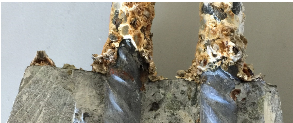
Figura 4.66. Aspecto del HAC-GOF-CV y de las barras tras la exposición a la carrera de mareas.
