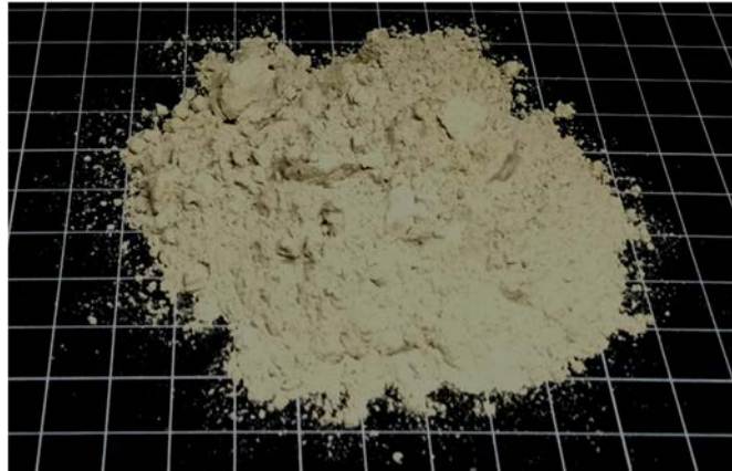
Figura 3.57. Aspecto del filler calizo.
