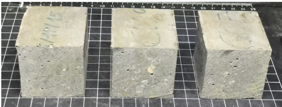
Figura 4.47. Aspecto del HAC-GOF-CV antes de los ciclos de hielo-deshielo.
