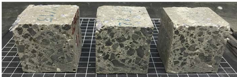
Figura 4.53. Aspecto del HAC-GEN-FE tras 5 ciclos de hielo-deshielo.
