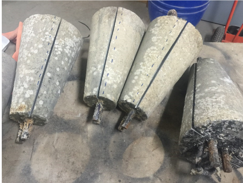
Figura 3.137. Aspecto de las muestras tras el corte longitudinal.
