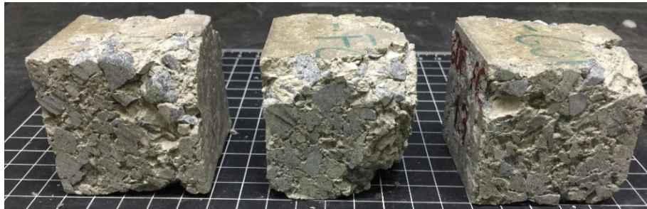
Figura 4.50. Aspecto del HAC-GOF-FC tras 5 ciclos de hielo-deshielo.
