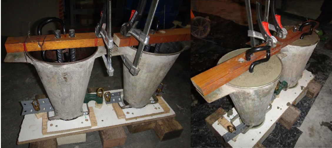
Figura 3.130. Aspecto de la preparación de los moldes (Izq.) y aspecto tras el hormigonado (Dcha.).
