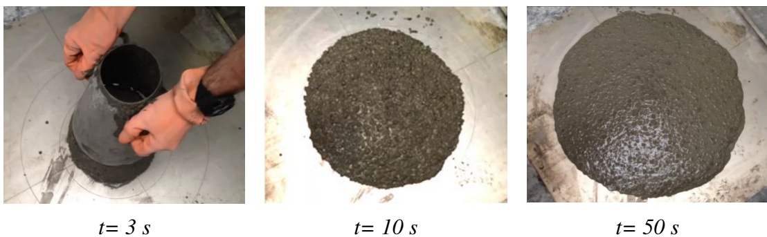
Figura 4.13. Secuencia y tiempos durante el escurrimiento del HAC-GEN-FE.
