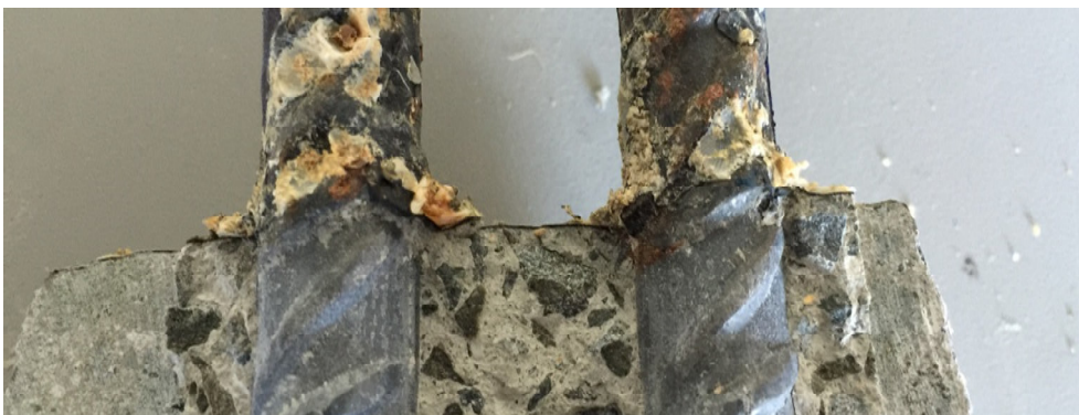
Figura 4.67. Aspecto del HAC-GOF-FE y de las barras tras la exposición a la carrera de mareas.
