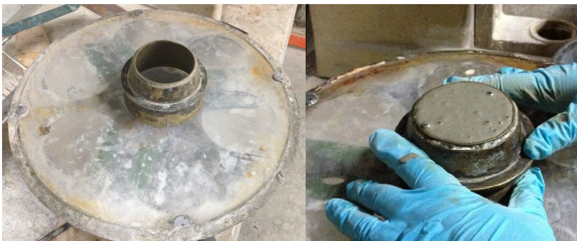
Figura 3.79. Ensayo de escurrimiento empleando el cono de la mesa de sacudidas.
