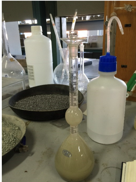
Figura 3.20. Aspecto del volumenómetro tras la incorporación del árido fino.
