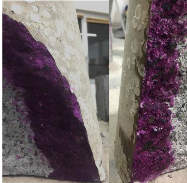
Figura 4.71. Detalle del frente de carbonatación de las probetas HAC-GOF-FE y HAC-GEN-FE expuestas al agua de mar durante 10 meses.
