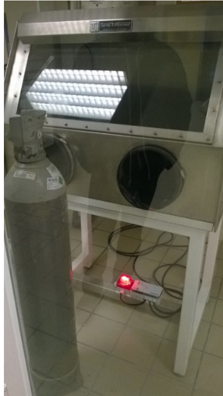
Figura 3.111. Aspecto de la cámara empleada para el ensayo de carbonatación acelerada.
