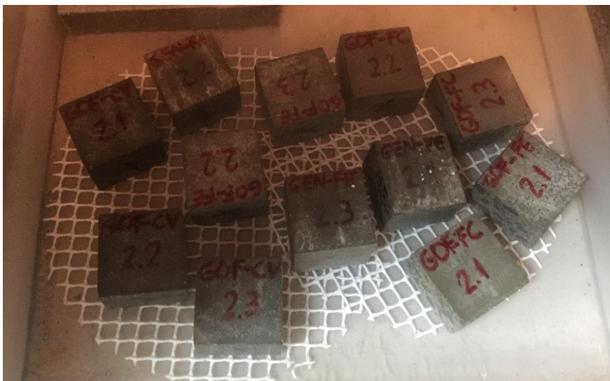
Figura 3.121. Detalle de las muestras sometidas a los ciclos de humedad-sequedad sumergidas.
