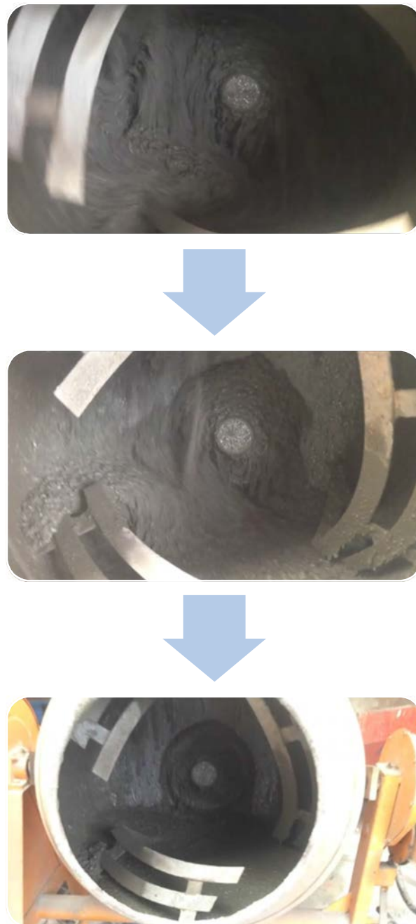
Figura 3.88. Consistencia esperada tras el amasado del hormigón.
