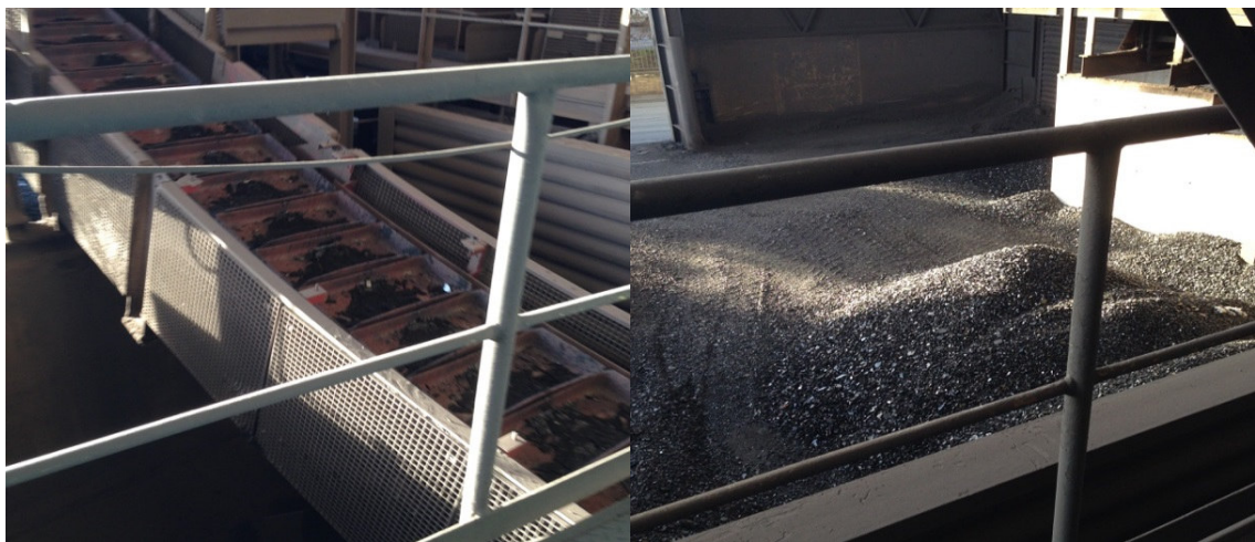
Figura 2.15. Transporte y enfriamiento de la escoria del cubilote en bandejas (Izq.) y detalle del acopio en la planta (Dcha.).
