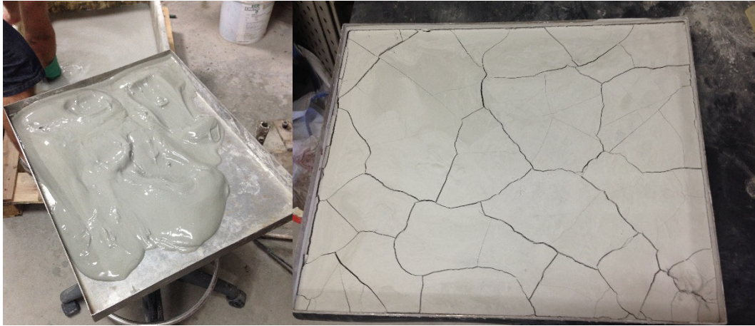
Figura 3.40. Aspecto del material antes y después del secado en estufa.
