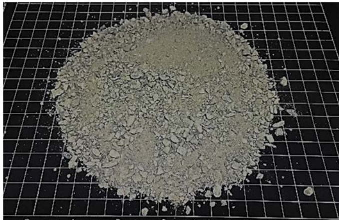
Figura 3.47. Arena de ofita ( 0 < D < 6 mm).
