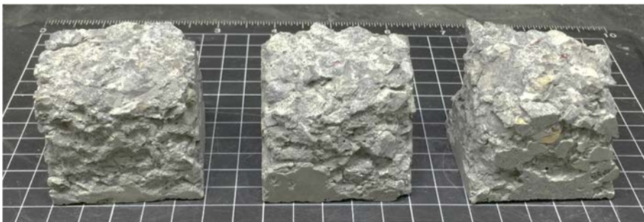
Figura 4.61. Aspecto del HAC-GOF-CV tras 21 ciclos de hielo-deshielo.
