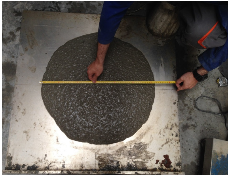
Figura 3.89. Determinación del escurrimiento del hormigón.
