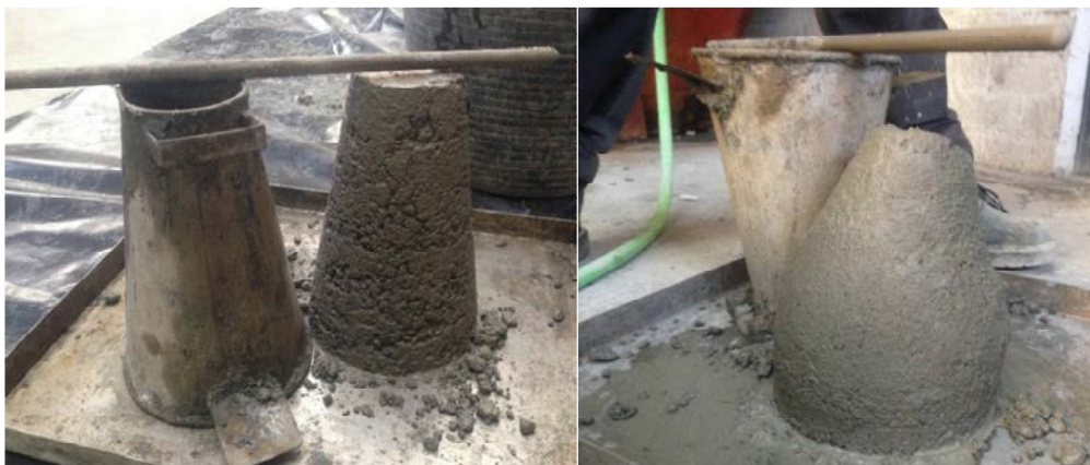
Figura 3.85. Hormigones convencionales con escorias de horno eléctrico.
