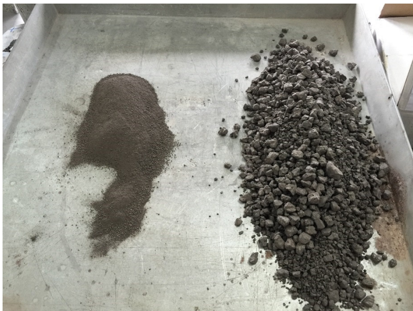
Figura 3.27. Fracción pasante y retenida por el tamiz 1,60 mm tras la realización del ensayo de desgaste Los Ángeles.
