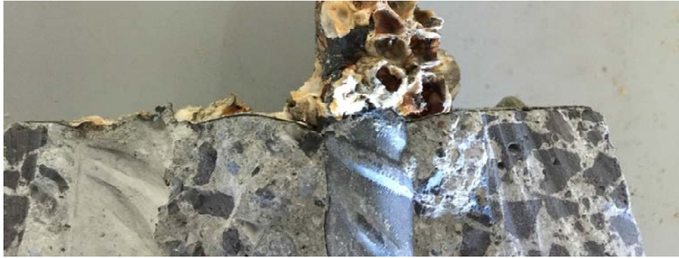
Figura 4.68. Aspecto del HAC-GEN-FE y una de las barras tras la exposición a la carrera de mareas.
