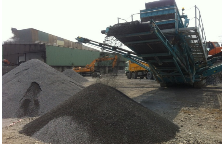
Figura 2.13. Cribado de la escoria y acopio del árido siderúrgico.
