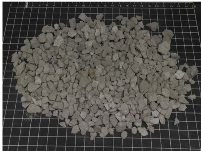
Figura 3.4. Gravilla de escoria de horno eléctrico de arco ( 6 < D < 12 mm).
