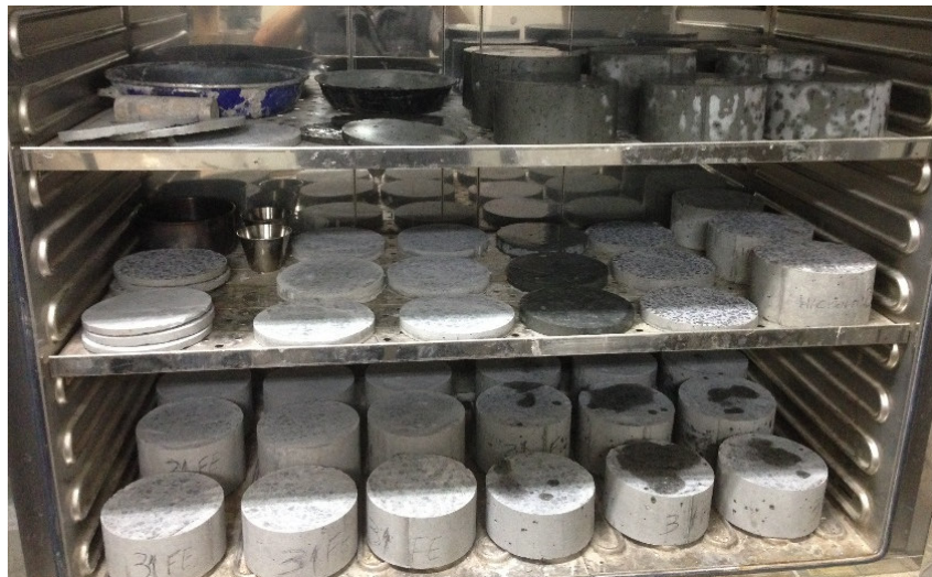
Figura 3.99. Aspecto de las submuestras obtenidas en su paso por la estufa de secado.
