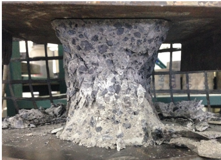
Figura 3.100. Aspecto de la rotura de una probeta cúbica tras el ensayo de compresión.
