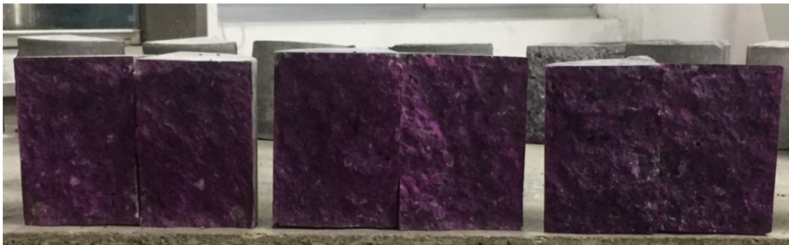
Figura 4.38. Aspecto de los hormigones tras la aplicación del virador.
