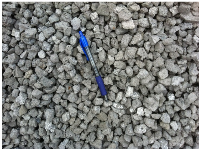
Figura 3.2. Aspecto de la grava de escoria de horno eléctrico de arco durante una visita a la acería.
