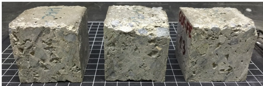
Figura 4.52. Aspecto del HAC-GOF-FE tras 5 ciclos de hielo-deshielo.
