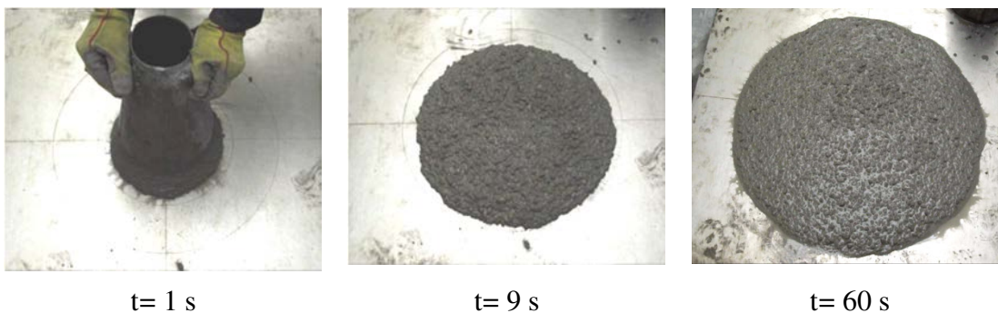
Figura 4.10. Secuencia y tiempos durante el escurrimiento del HAC-GOF-FC.
