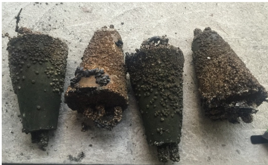
Figura 3.135. Aspecto de las probetas tras la exposición a la intemperie y los ciclos de mareas.
