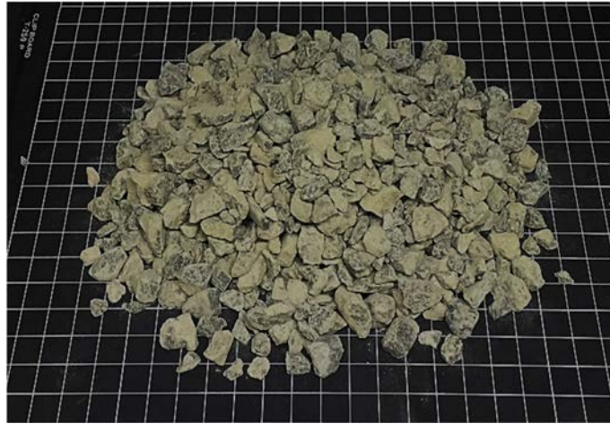
Figura 3.48. Gravilla de ofita ( 6 < D < 12 mm).
