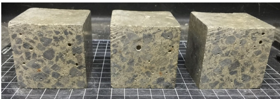
Figura 4.45. Aspecto del HAC-GEN-FE tras los ciclos de humedad-sequedad.
