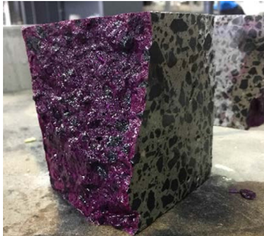
Figura 4.36. Aspecto de la dosificación HAC-GEN-FE sometida a 90 días de exposición de carbonatación acelerada tras aplicar la disolución con fenolftaleína.
