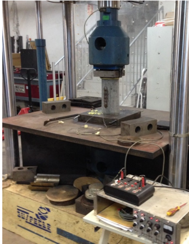
Figura 3.105. Fotografía de la probeta instrumentada en la prensa.
