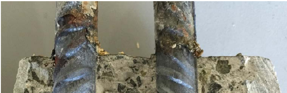
Figura 4.65. Aspecto del HAC-GOF-FC y de las barras tras la exposición a la carrera de mareas.
