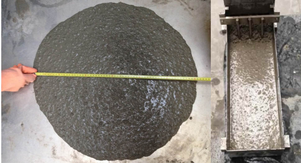
Figura 4.4. Aspecto de los ensayos de escurrimiento (izda.) y caja en L (dcha.) empleando la distribución de áridos “GEN-AEN-ASI INICIAL”.
