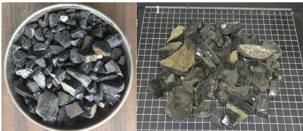
Figura 3.34. Aspecto de la escoria de cubilote vitrificada.
