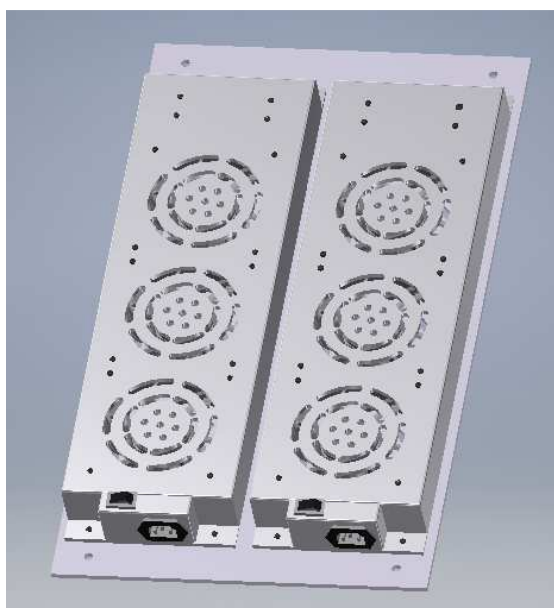
Figura 2: Sistema de ventilación suplementario para neveras
