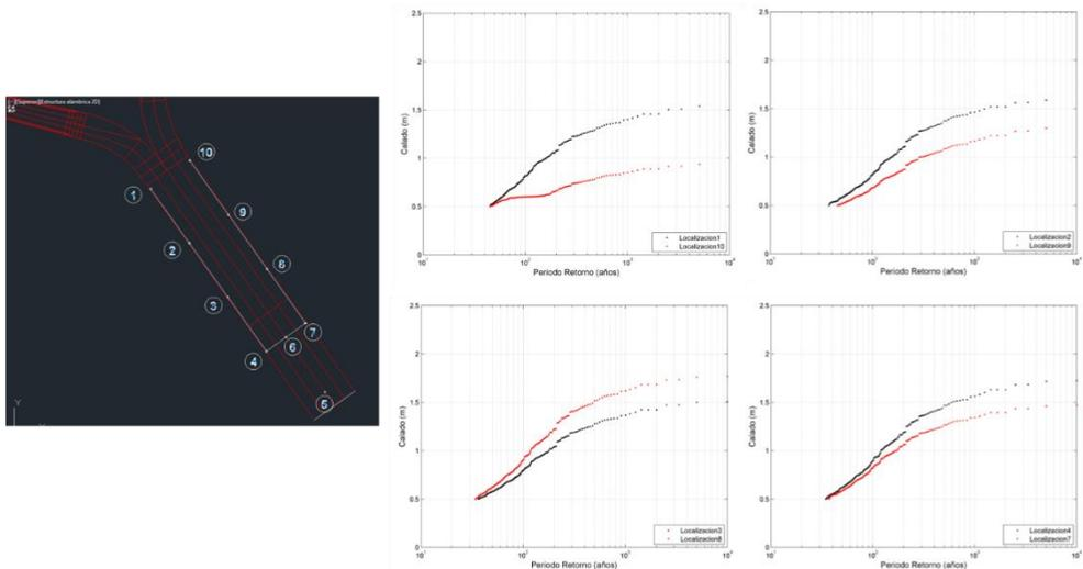
**Figura 7** Localización de los puntos de caracterización de la cota del canal y ajustes extremales del calado para las localizaciones 1 y 10 (superior izquierda), 2 y 9 (superior derecha), 3 y 8 (inferior izquierda) y 4 y 7 (inferior derecha).
