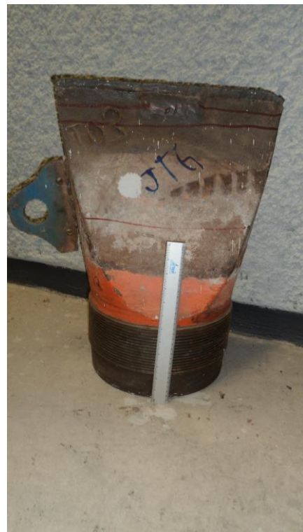
Figura 2. Anclaje retirado de servicio para la obtención de las probetas de tracción, mecánica de fractura y metalografía.
