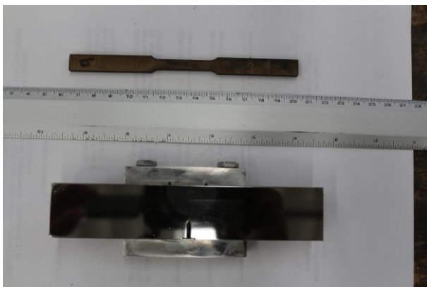
Figura 3. Geometría de la probeta de tracción y flexión en tres puntos SE(B).
