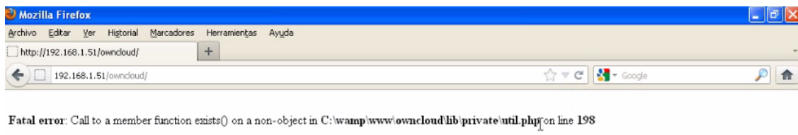
Figura 68 - Mensaje de error al intentar acceder a Owncloud después de modificar el usuario de la base de datos.
