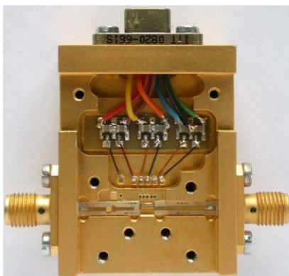
Fig. 1. Amplificador de 4-12 GHz. Chasis de 31.3 x 40 x 15 mm<sup>3</sup>
