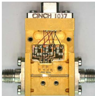
Fig. 4. Amplificador de 25-34 GHz. Chasis de 20.6 x 32.5 x 12 mm<sup>3</sup>
