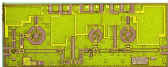
Fig. 2. Fotografía del MMIC LNA de 4-12 GHz. Tamaño 2.5 x 1 mm<sup>2</sup>
