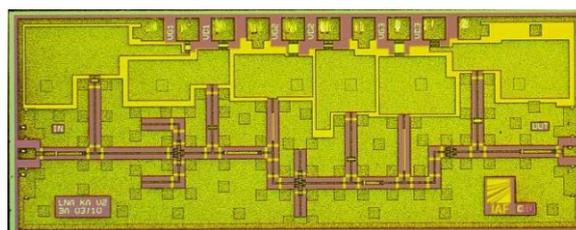
Fig. 5. Fotografía del MMIC LNA de 25-34 GHz. Tamaño 2.5 x 1 mm<sup>2</sup>
