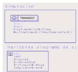
Fig. 10. Parámetros de simulación necesarios para el diagrama de ojo
