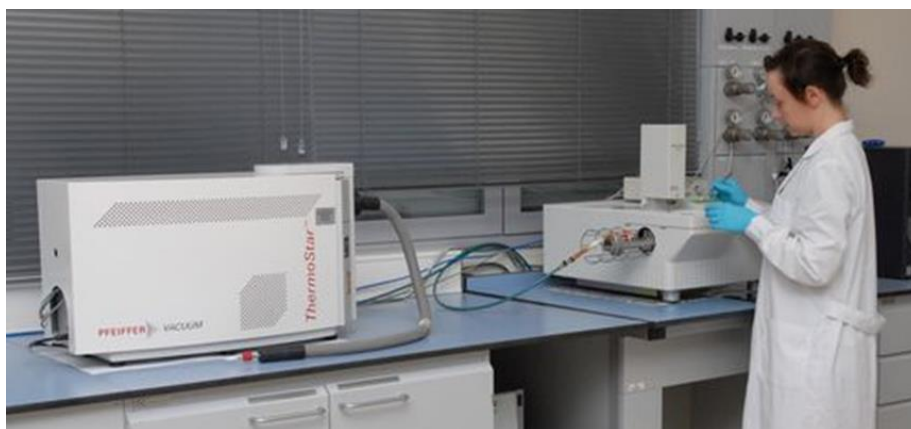
Fig. 4: Equipo de TG-ATD METTLER TOLEDO modelo TGA/SDTA851e/LF/1600 de la Unidad de Análisis Térmico y Sólidos Porosos de la Universidad de Alicante.
