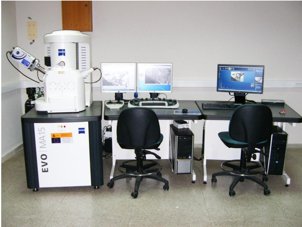
Fig.1: Microscopio electrónico de barrido con espectroscopía de dispersión de energía de rayos X (MEB-EDS) marca Carl Zeiss, modelo EVO MA15 con detectores de electrones secundarios, retrodispersados y de rayos X (Oxford Instruments), perteneciente al Laboratorio de la División de Ciencia e Ingeniería de los Materiales (LADICIM), E.T.S. de Ingenieros de Caminos de la Universidad de Cantabria.
