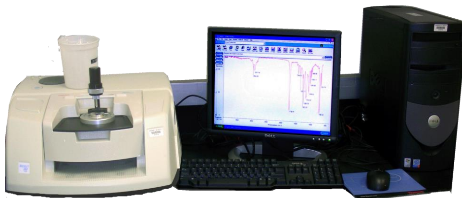
Fig.3: Espectroscopio de IR Thermo Nicolet 380 FT-IR equipado con sistema ATR Smart Orbit Diamond, perteneciente al Departamento de Física de la Universidad de Coimbra
