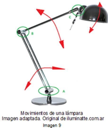
todos conocemos es una lámpara de mesa como la de la imagen 9 . Es un mecanismo muy simple que consta de 3 juntas, las cuales permiten el giro tal como las flechas rojas muestran. Si dejamos la lámpara encima de la mesa, vemos que la junta de abajo (punto A), se va a quedar fija, sin embargo el punto B, gracias a la estructura de este artillugio, se moverá en un arco de circunferencia alrededor de A (siempre a la misma distancia AB ya que es una barra
