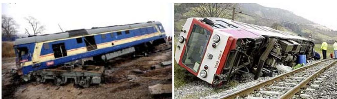
**Figura 1. Accidentes de vehículos inducidos por el efecto del viento lateral en el ámbito del transporte ferroviario y de carretera (Rolén et al., 2004; Shao et al., 2011).**
