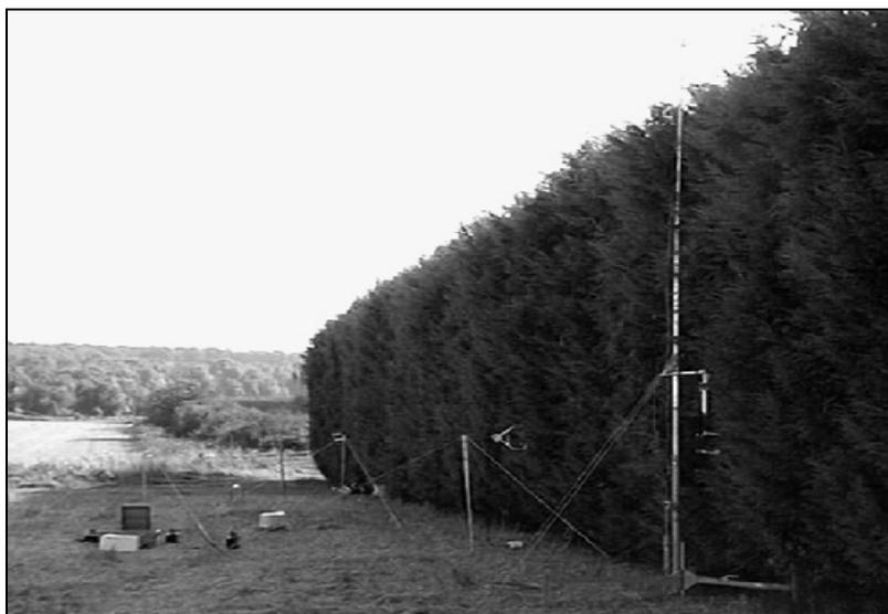
Figura 18. Anemómetros ultrasónicos ubicados a un lado inmediatamente próximo a la barrera formada por cipreses de una altura de 8 m y un espesor de 3 m, durante el experimento en Tuzet y Wilson (2007).
