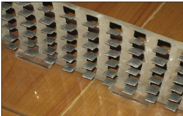
Figura 24. Modelo de barrera permeable de metal formada provista de deflectores (Chen et al., 2012).
