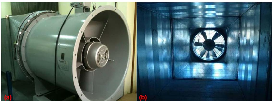
Figura 35. Ventilador del túnel aerodinámico (a) y rejilla de protección (b).
