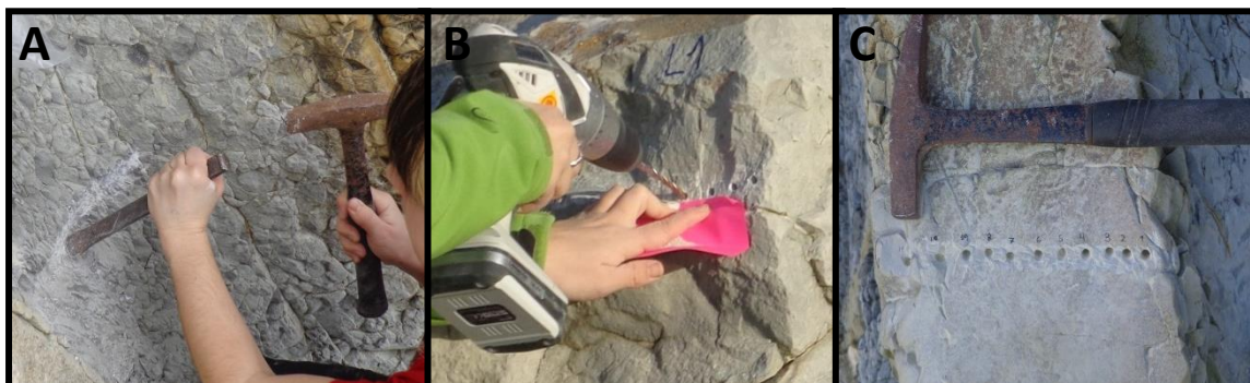
Figura 12: A) limpieza de la zona superficial a muestrear mediante el cincel; B) Obtención de las muestras mediante el taladro inalámbrico; C) Ejemplo de la frecuencia de muestreo utilizada en la capa L6.
