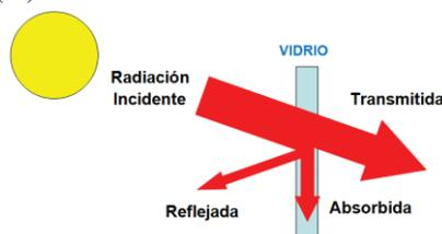
Figura 1.- Principio de funcionamiento del vidrio
