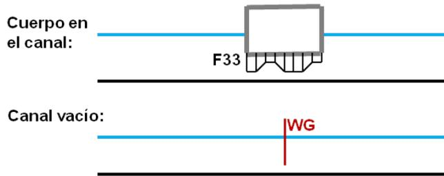
**Figura 5.3:** Obtención de la fuerza de excitación mediante simulaciones CFD.
