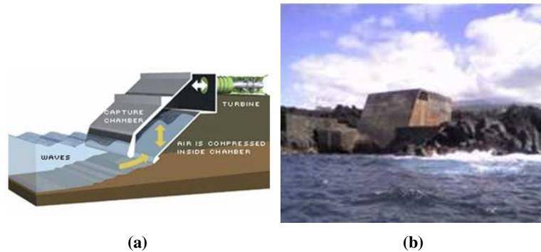
**Figura 2.3:** (a) Esquemas de Limpet plant (Escocia) y (b) Pico plant (Azores, Portugal).
