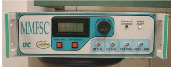
Figura 3. Unidad opto-electrónica para el control de error de foco en procesos de soldadura industrial.
