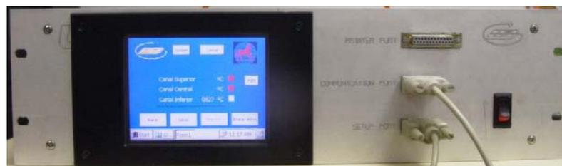
Figura 2. Unidad opto-electrónica del sistema sensor de temperatura.
