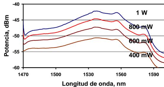
Fig. 4.- Potencia de ruido ASS obtenida aplicando potencias de bombeo de 400, 600, 800 y 1000 mW obtenidas para diferentes potencias de bombeo.
