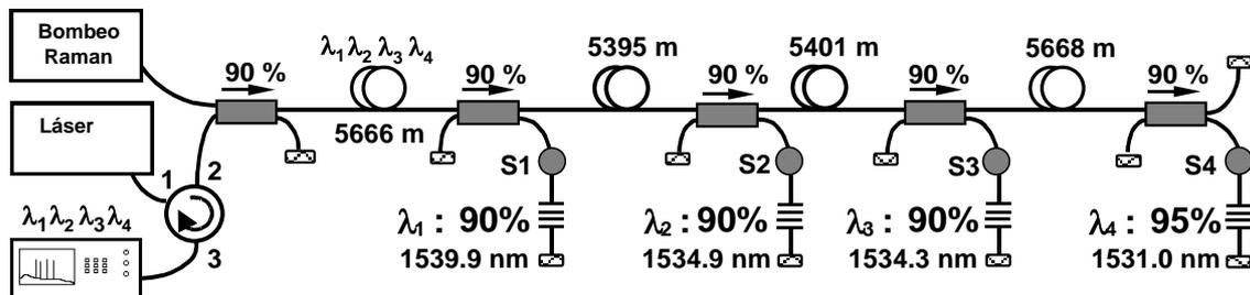
Fig. 1.- Red de multiplexación de sensores con amplificación Raman distribuida.
