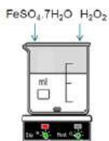
Figura 2.4. Sistema experimental del proceso Fenton
