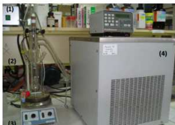
Figura 2.6. Equipo experimental procesos fotoquímicos. (1) Fuente de alimentación, (2) Reactor, (3) Agitador magnético, (4) Equipo de refrigeración [31]
