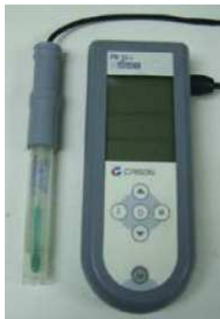
Figura 2.9. pH-metro portátil pH 25+ (Crison)
