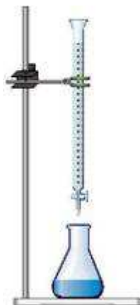
Figura 2.5. Sistema de valoración (Bureta + erlenmeyer)
