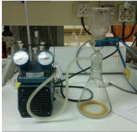
Figura 2.11. Sistema de filtrado
