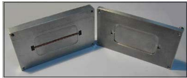
Fig. 2. Transición guía de onda-microstrip
