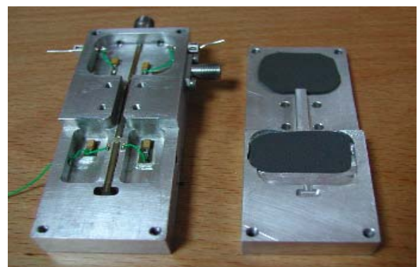
Fig. 7. Receptor para un sistema MVDS
