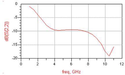
Fig.5. Adaptación de salida.
