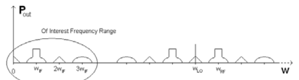
Fig. 4. Espectro de potencia típico a la salida de un downconverter .
