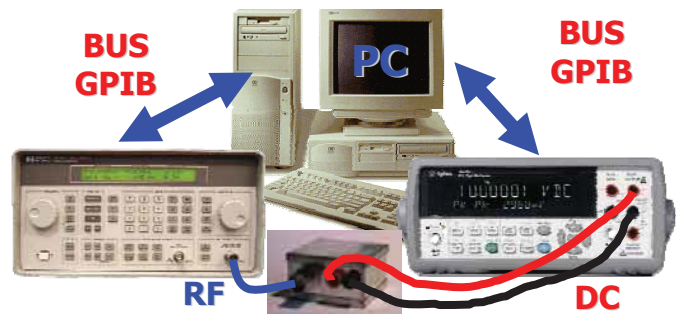
Fig. 10. Esquema de medida utilizado en el calibrado del detector Schottky desarrollado.
