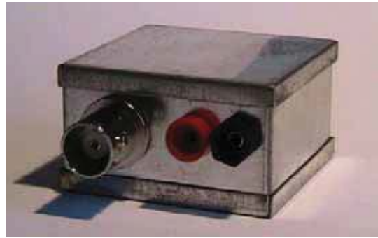
Fig. 9. Fotografía del circuito detector a diodo Schottky desarrollado en el presente trabajo montado y listo para su uso.
