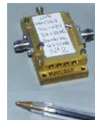
Fig. 2. Útil con conectores 2.4 mm con el amplificador HMC263 de Hittite.
