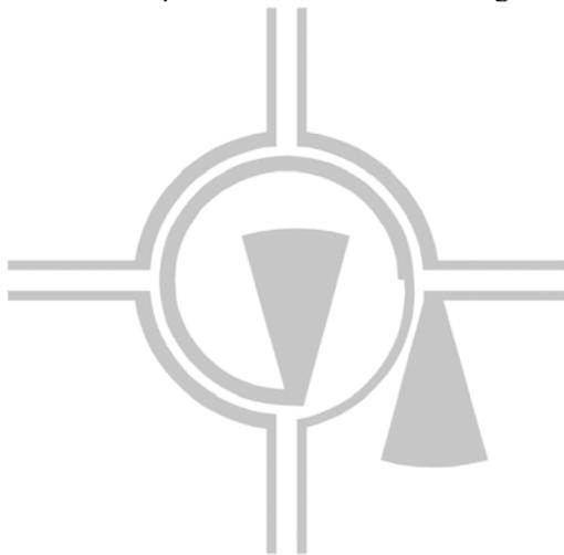
Fig. 7. Anillo híbrido CPW con máscara inversa
