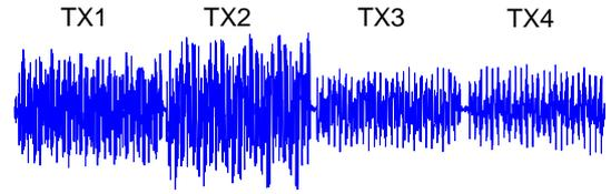
Fig. 4. Señal recibida por una de las antenas
