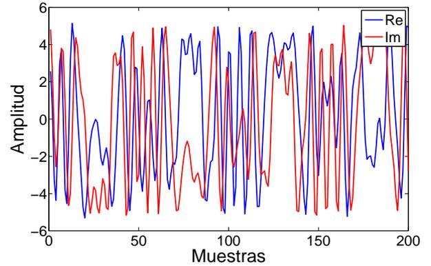
Fig. 3. Minimización del PAPR (N=20 portadoras).
