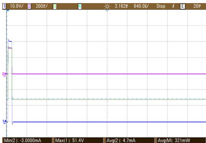
Fig. 10. Captura de la pantalla del osciloscopio donde se puede un periodo (6.4 ms) de la forma de onda de la corriente, I_{DD}(t) ('____') (mA), la tensión, V_{DD}(t) ('____') (V) y la potencia consumida P_{DC}(t)=V_{DD}(t) \cdot I_{DD}(t) ('____') (mW).
