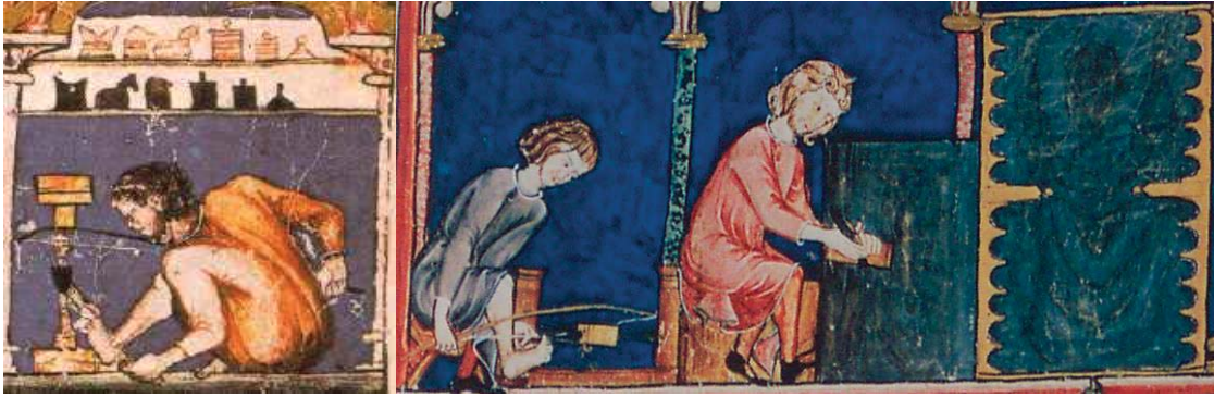
Figura 1-5: Fabricación de piezas torneadas mediante arco de violín. “Libro de los Juegos” de Alfonso X “El Sabio”
