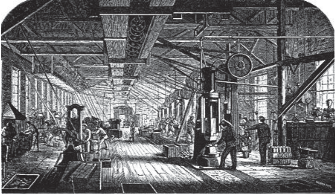
Figura 1-10: La fuerza motriz para todas las máquinas de la fábrica proviene del eje central situado en el techo, que era accionado por una rueda hidráulica exterior. Las máquinas estaban conectadas al eje por medio de correas de transmisión.
