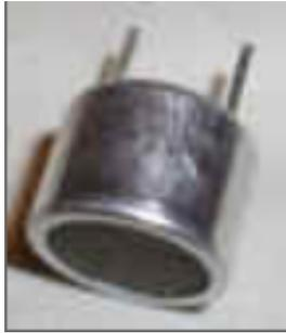
*Figura 7.1: Emisor-Receptor ultrasónico Hexamite HX25TR.*
