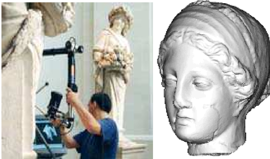
Figura 2: Ejemplo de escáner 3D aplicado a la restauración arqueológica: (izquierda) proceso de escaneado; (derecha) figura obtenida por computador. ( Fuente: Cyberware Inc., http://www.cyberware.com ).
