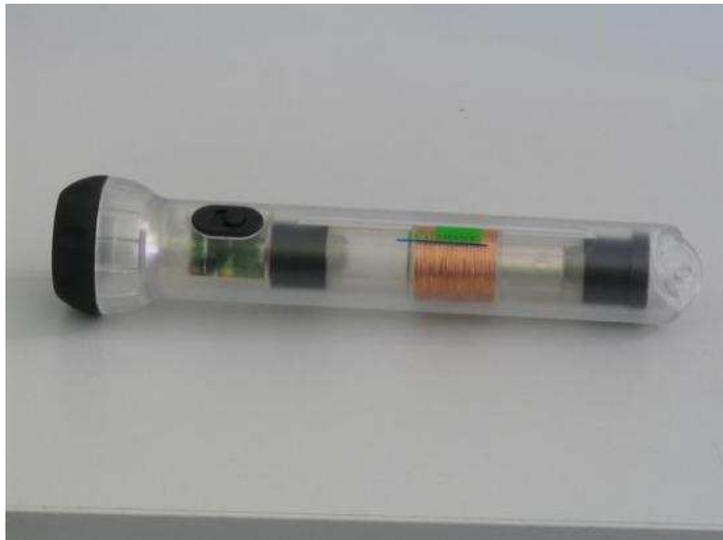
**Figura 3.2:** Ejemplo de Generador Lineal
