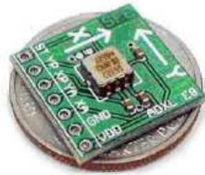
**Figura 4.8:** Acelerómetro Micromecánico MEMS
