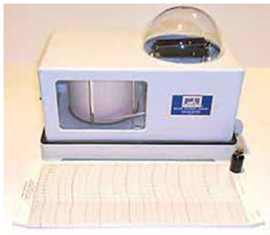
Exemple de pyranographe Photo : emaze.com
