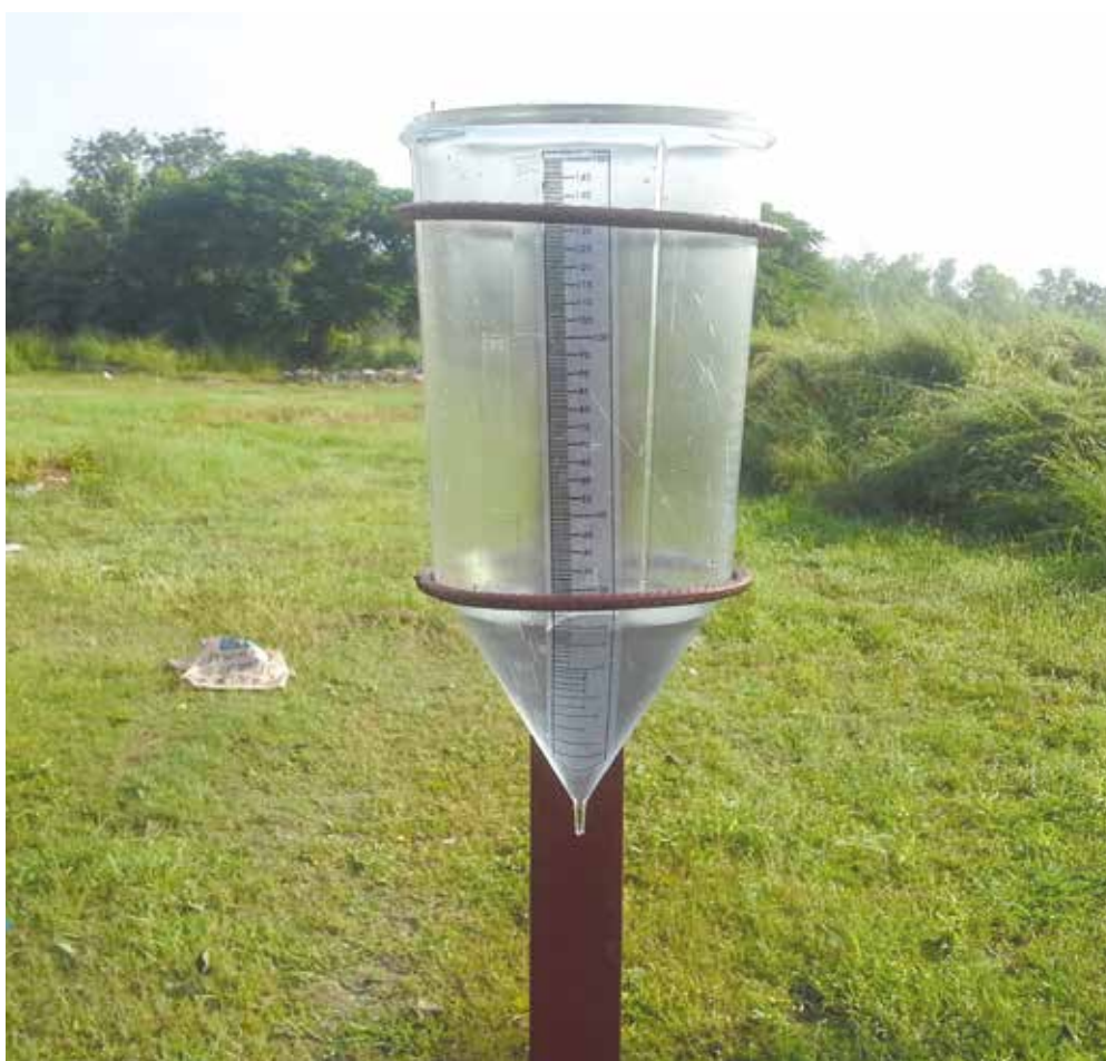
Exemple de pluviomètre paysan à la station agro-météorologique de ICRISAT à Samanko. Photo: Bouba Traoré, ICRISAT-Mali
