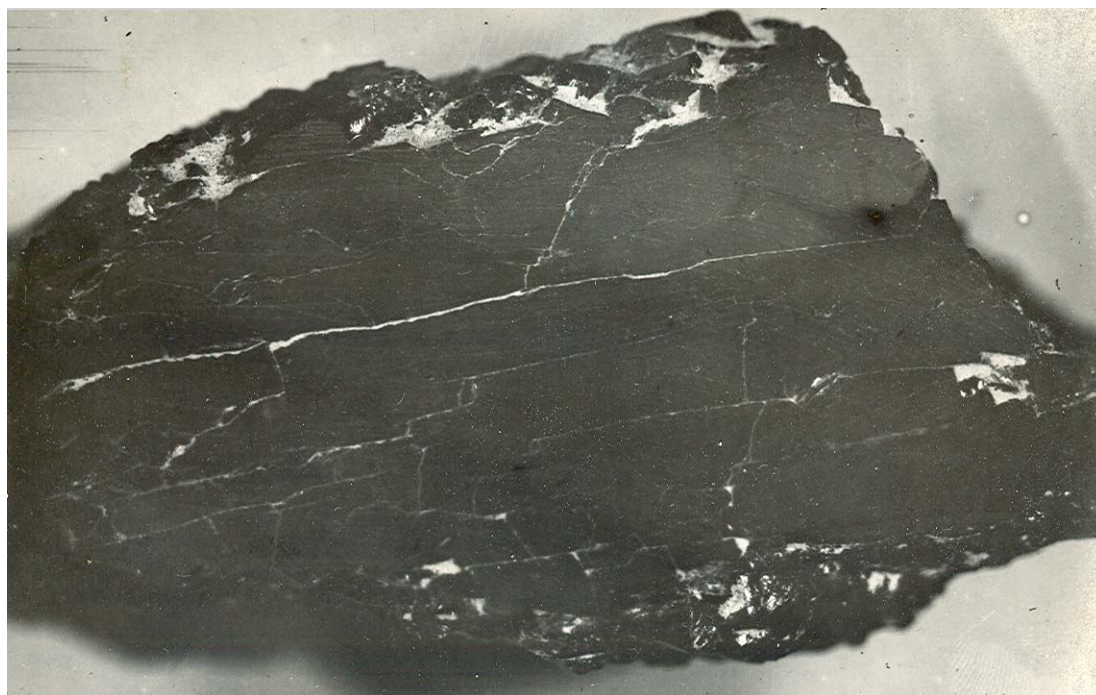
Рисунок 1 Штуф угля с декорированной (проявленной) трещиноватостью
