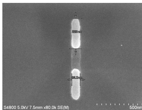
図 3.20 NDA ドライ+ウェットエッチング後 SEM 観測結果.
