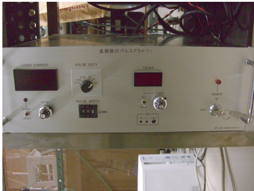
図 4.8: パルスドライバ . レーザーダイオードに流す電流の大きさ , パルス幅 , デューティ比をこの装置で設定する . また , レーザーダイオードは高温に弱いため , 温度表示および冷却用ファンのコントロールもされている .
