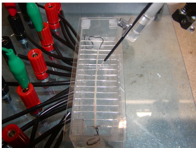
図 4.14: 図 4.13 の実験チャンバ部分の拡大画像. チャンバに張られた銀線上に坐骨神経(白い紐状の物体)が載せられていることが分かる. 4.1.1 で述べたように, 坐骨神経の両端は木綿糸で縛っており, チャンバ端に置いたリンガー液で湿らせた綿に触れさせている. 光ファイバーはチャンバふたの中央に空けられた穴からチャンバ内に挿入しており, 先端は坐骨神経に接している.
